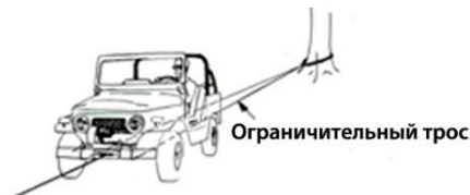
Рис. 20.10 Пример того, как правильно ограничивать автомобиль при транспортировке тяжелых грузов, когда колесных блоков недостаточно. Ограничительный трос или цепь прикрепляется к якорю как можно ниже, проходит под автомобилем и надежно крепится за прочие части установочного комплекта лебедки. Способ крепления к задней раме или балке моста имеет определенный риск. Мощности лебедки достаточно, чтобы сломать или погнуть раму или балку моста
