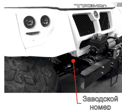
Рис. 4.3 Место обозначения заводского номера ВТС
