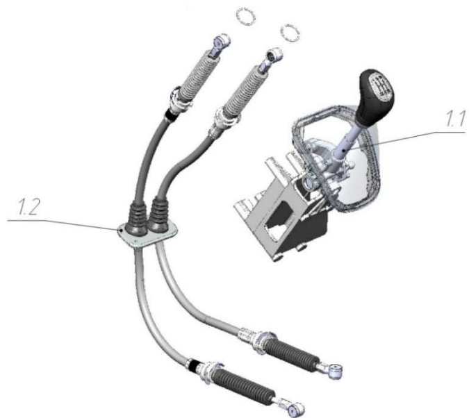
Рис. 6.7 Мастер-опора и тросы управления КПП
