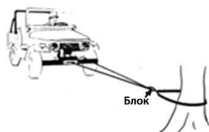
Рис. 20.7 Использование блока дает механическое усилие 2:1. К тому же вдвое уменьшается нагрузка на трос и лебедку. Соответственно, мотор будет крутить быстрее и с меньшим потреблением энергии. Можно работать с длинным тросом и не бояться перегрева мотора
