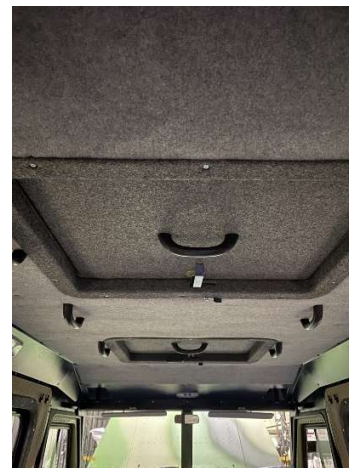
Рис.20.36 Дополнительный люк на крыше
