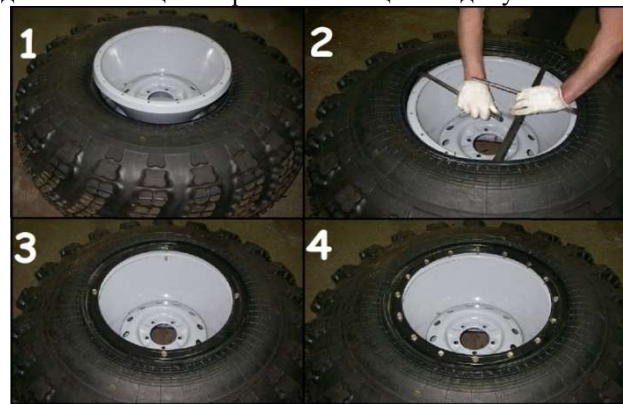
Рис. 10.4 Порядок монтажа шины ТРЭКОЛ
