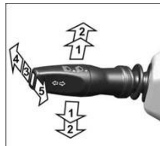
Рис. 5.12 Положение рычага указателей поворота и света фар
