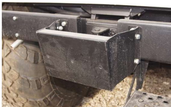
Рис.20.32 Приспособление для установки лодочного мотора
