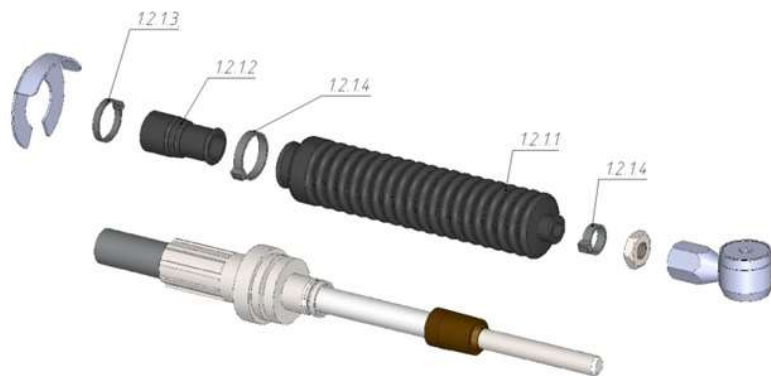
Рис. 6.8 Заменяемые части троса
