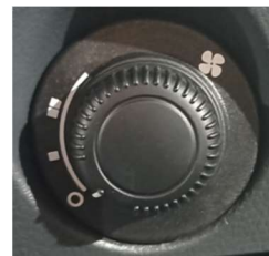
Рис. 5.7 Переключатель вентилятора заднего дополнительного отопителя
