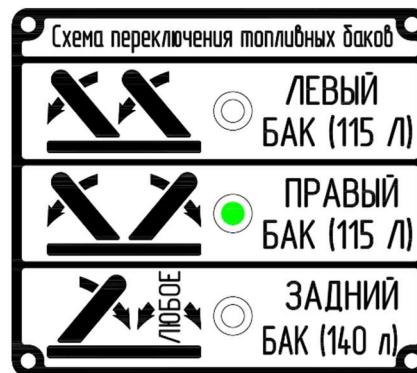
Рис. 11.8 Информационная табличка с указанием положений кранов для переключения между топливными баками
