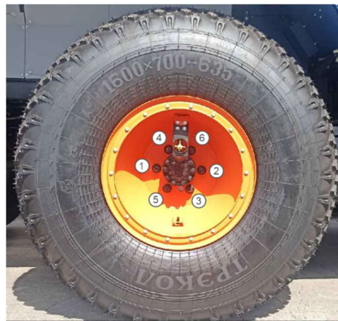
Рис. 14.4 Порядок затяжки гаек крепления колёс
