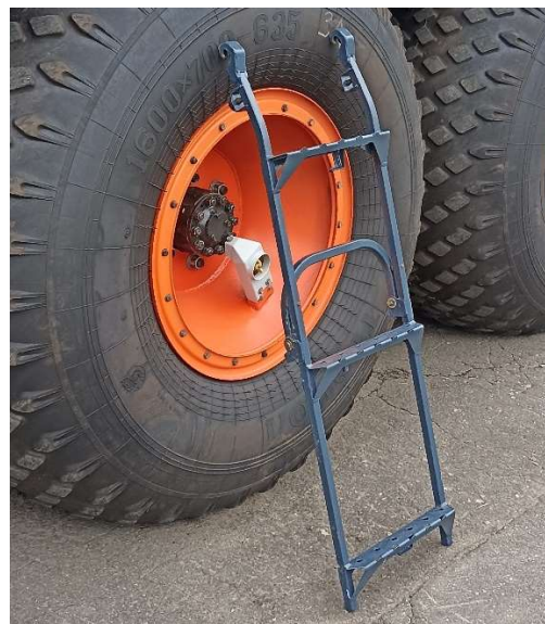
Рис. 6.17 Установка лестницы с опорой на колесо
