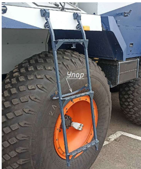
Рис. 6.16 Установка лестницы для доступа к моторному отсеку
