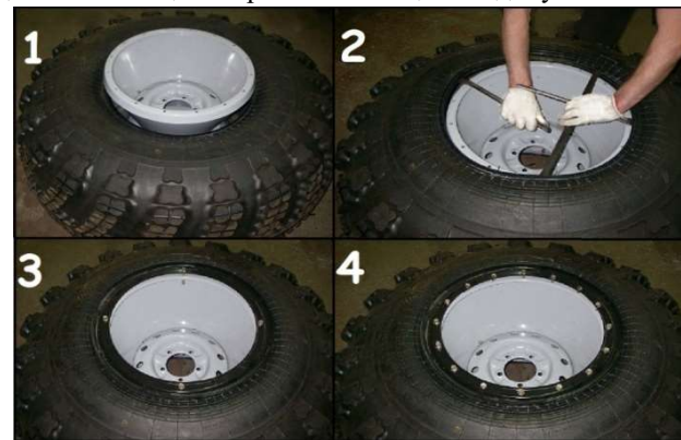
Рис. 14.6 Порядок монтажа шины ТРЭКОЛ
