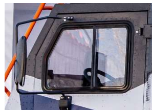
Стеклопакеты сдвижные (боковые двери кабины)
