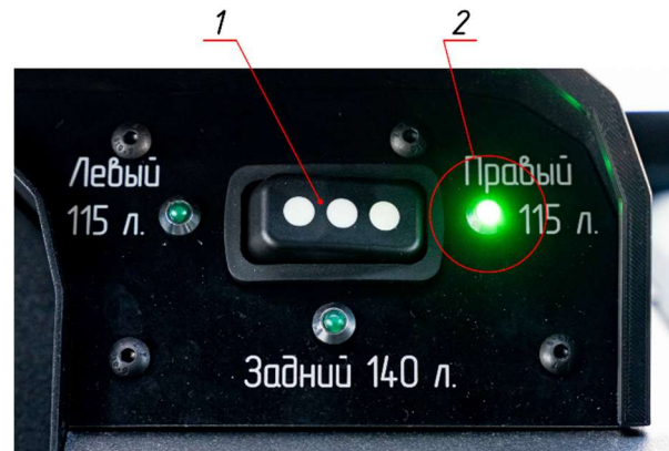
Рис. 11.9 Переключатель стрелочного прибора КП указания уровня топлива в баке
