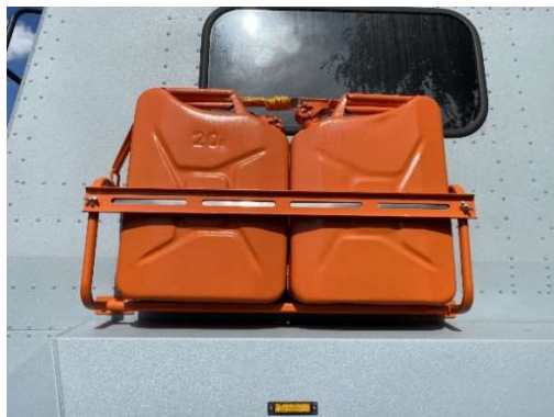
Рис. 20.30 Кронштейны крепления канистр
