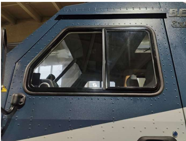
Рис.20.34 Стеклопакеты сдвижные – передние боковые двери
