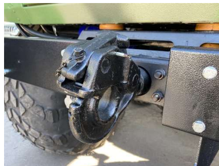
Рис. 20.24 Буксирный прибор (фаркоп) с розеткой
