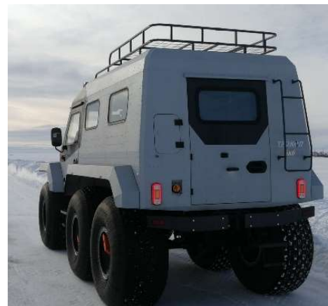
Рис.20.28 Багажник на крышу с лестницей
