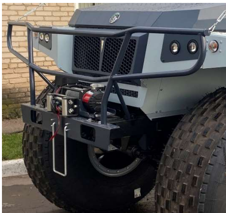
Рис.20.26 Защита переднего бампера
