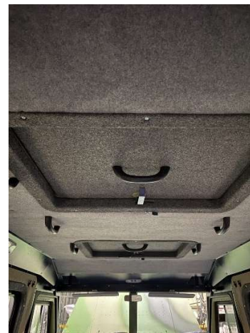
Рис.20.36 Дополнительный люк на крыше
