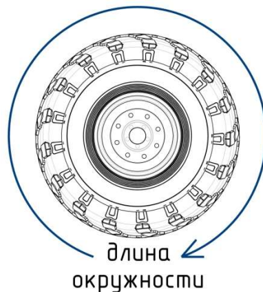
Рис. 10.2 Длина окружности колеса
