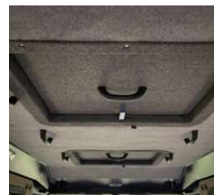
Дополнительный люк на крыше
