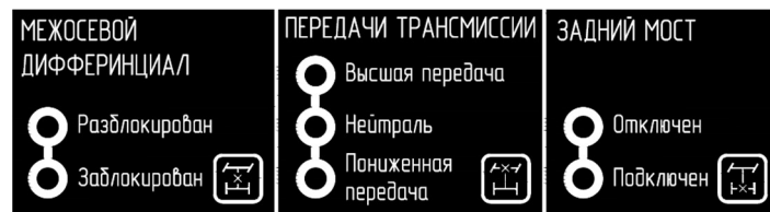
Рис. 6.3 Схема управления раздаточными коробками
