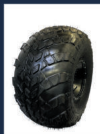
Шина сверхнизкого давления 1350 x 700-533 (2 слоя корда)
