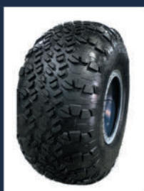
Шина серхнизкого давления 1650 x 700-635 (2/4 слоя корда)
