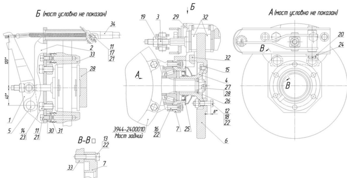
Рис. 6.26 Устройство стояночного тормоза
