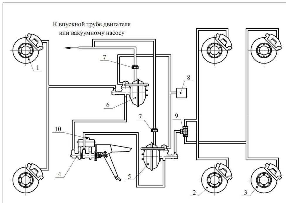
Рис. 6.23 Схема гидропривода тормозов:
