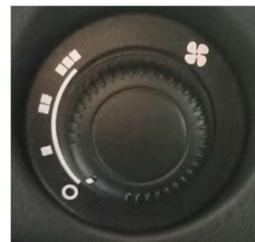
Рис. 5.12 Переключатель вентилятора переднего основного отопителя
