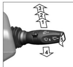
Рис. 5.17 Положения рычага переключателя стеклоочистителя и стеклоомывателя
