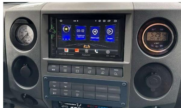
Рис.20.48 Автоматомангнитола 2 DIN с монитором (Bluetooth/MP3/USB), динамики, радиоантенна
