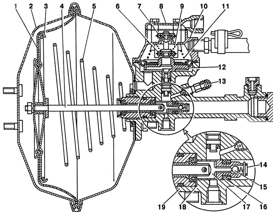
Рис. 6.25 Гидروвакуумный усилитель
