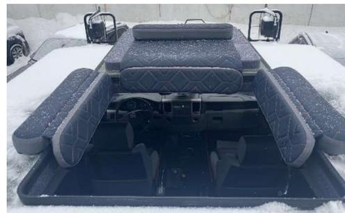
Рис.20.37 Мягкие опоры на быстросъемном креплении с обечайками люка
