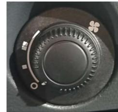
Рис. 5.10 Переключатель вентилятора заднего дополнительного отопителя
