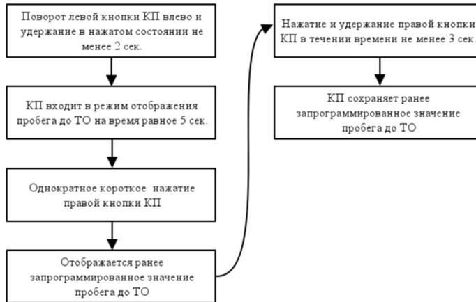
Блок-схема 5.1 Алгоритм сброса пробега до ТО.
