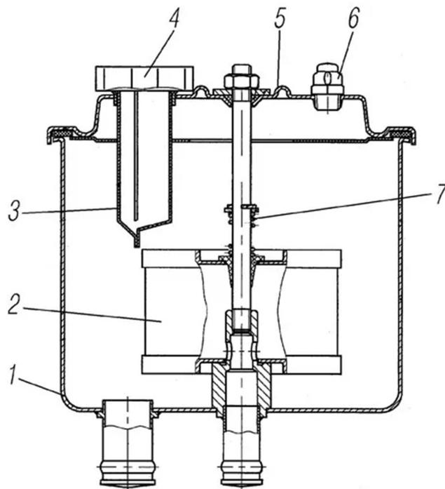
Рис. 6.22 Бачок усилителя рулевого управления:
