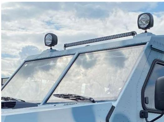
Рис.20.27 Светодиодная балка
