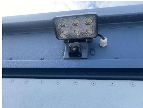
Рис. 20.44 Камера заднего вида
