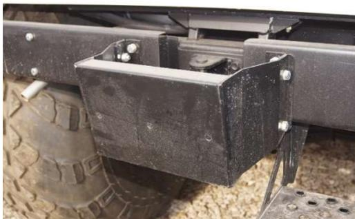
Рис.20.23 Приспособление для установки лодочного мотора
