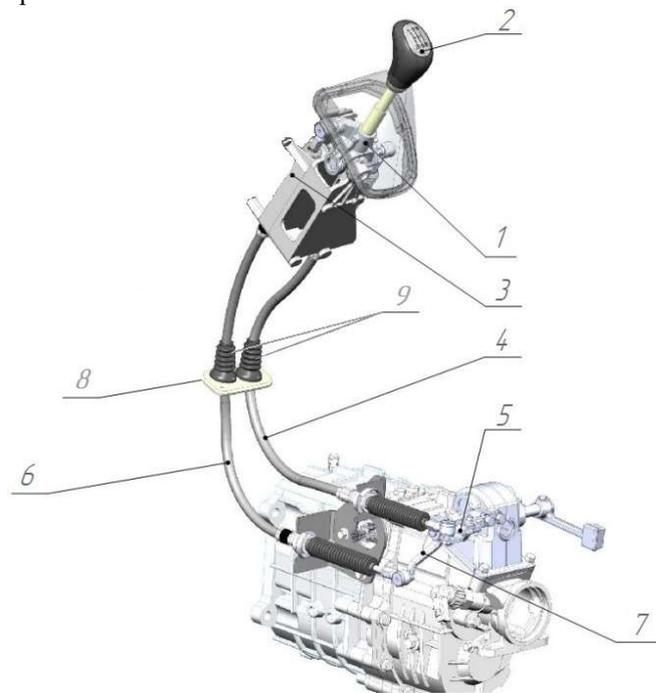
Рис. 6.2 Механизм управления коробкой передач
