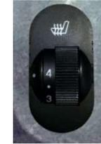
Рис. 5.18 Регулятор управления подогревом сидений
