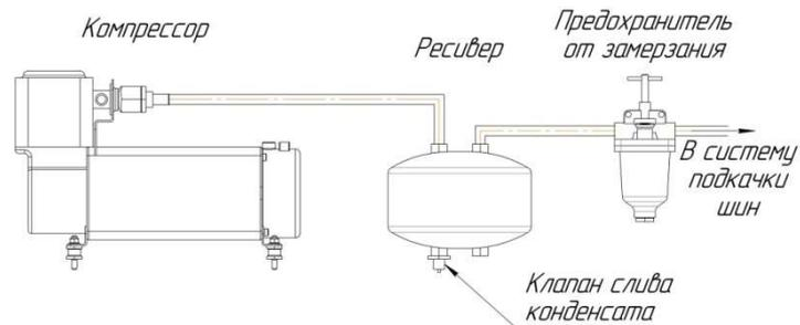
Рисунок 20.4 Схема системы предохранения СРДВШ от замерзания
