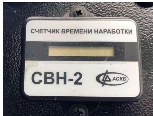
Рис.20.49 Счётчик моточасов
