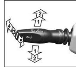
Рис. 5.14 Положение рычага указателей поворота и света фар
