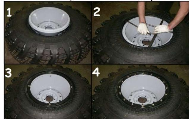
Рис. 10.4 Порядок монтажа шины ТРЭКОЛ
