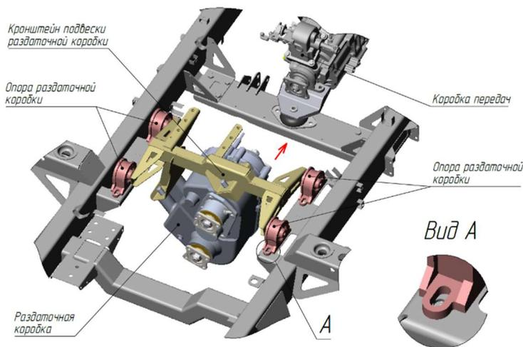
Рис. 6.19 Установка опор кронштейна подвески раздаточной коробки
