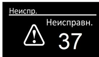
4. После появления на экране кода ошибки 37 необходимо демонтировать предохранитель 25А (установлен под капотом ВТС на моторном щите).
