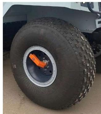
Рис.20.33 Система централизованной подкачки колёс
