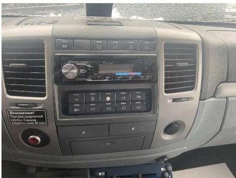
Рис.20.47 Автоматомангнитола 1 DIN, динамики, радиоантенна
