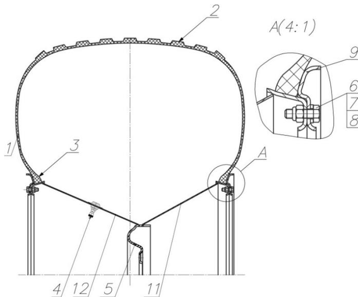
Рис. 10.3 Шина 1300х600-533 ТРЭКОЛ с колесом в сборе
