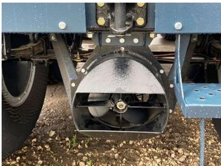
Рис.20.22 Водомётный движитель
