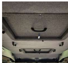
Дополнительный люк на крыше
