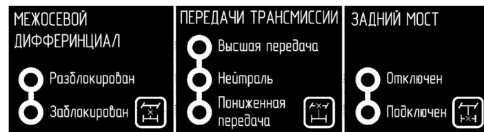
Рис. 6.3 Схема управления раздаточными коробками
