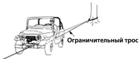
Рис. 20.7 Пример того, как правильно ограничивать ВТС при транспортировке тяжелых грузов, когда колесных блоков недостаточно. Ограничительный трос или цепь прикрепляется к якорю как можно ниже, проходит под ВТС и надежно крепится за прочие части установочного комплекта лебедки. Способ крепления к задней раме или балке моста имеет определенный риск. Мощности лебедки достаточно, чтобы сломать или погнуть раму или балку моста
