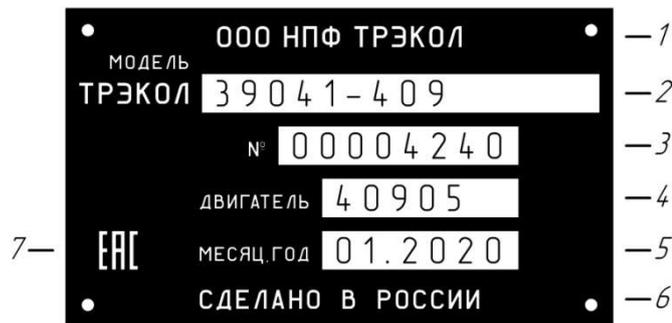
Рис. 4.2 Табличка заводских данных ВТС:
