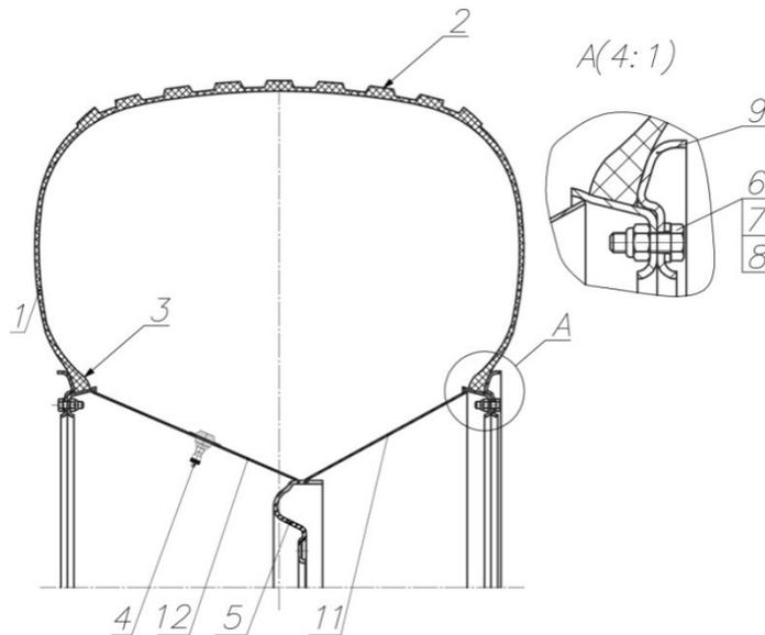
Рис. 10.3 Шина 1300x600-533 ТРЭКОЛ с колесом в сборе
