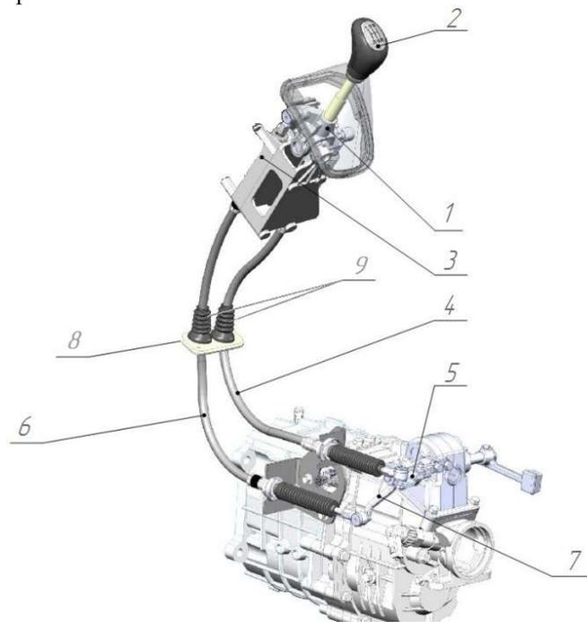
Рис. 6.2 Механизм управления коробкой передач
