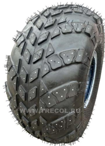
Рис. 20.35 Шина шипованная ТРЭКОЛ 1350х700-533
