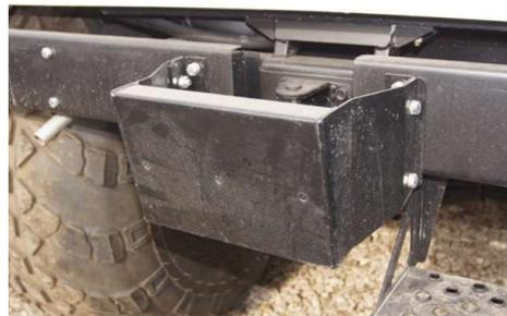
Рис.20.20 Транец для подвесного лодочного мотора
