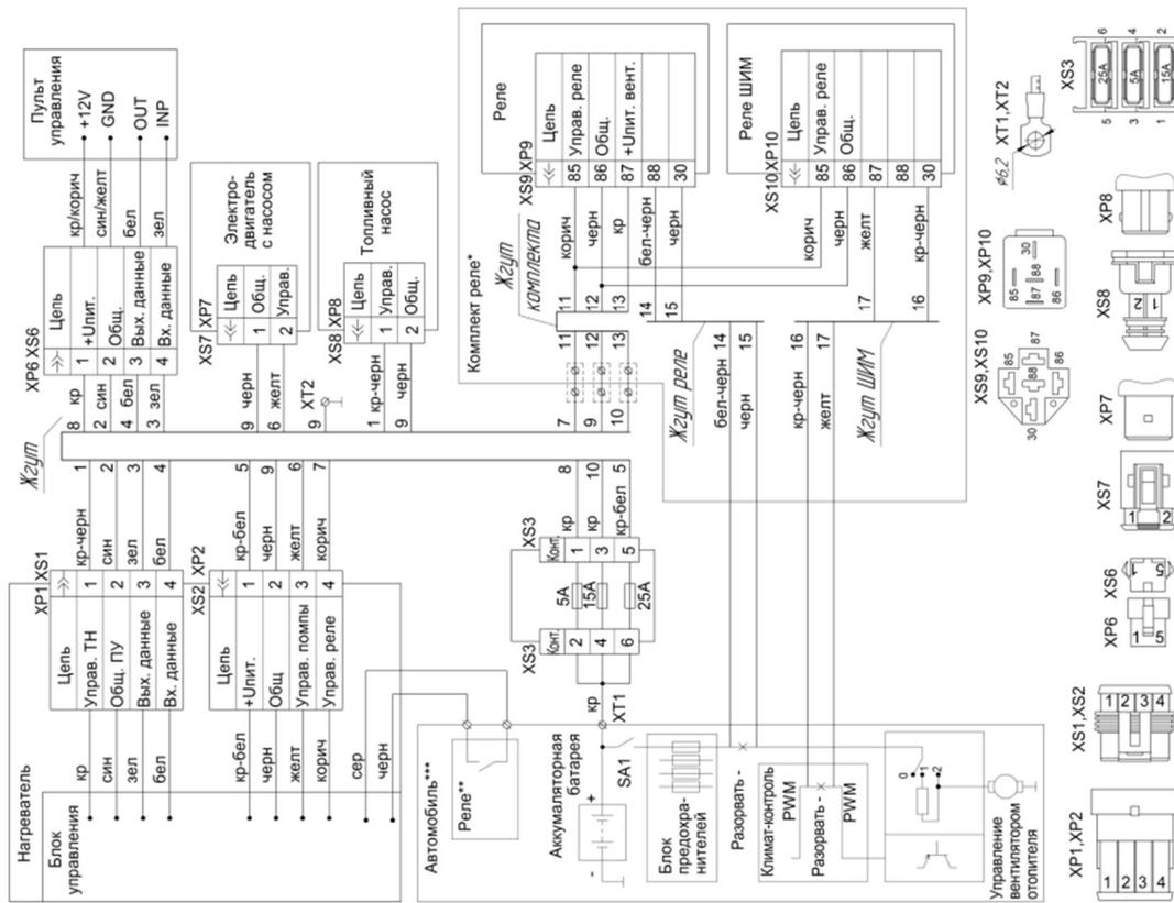
Рис. 20.12 Электрическая схема подключения подогревателя
