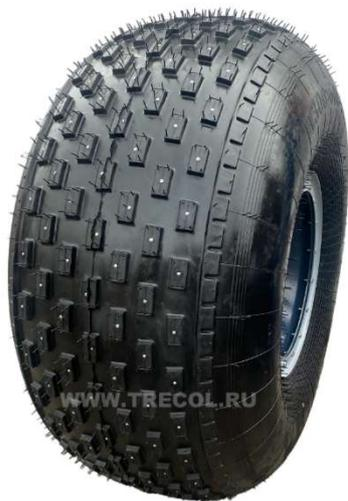
Рис. 20.34 Шина шипованная ТРЭКОЛ 1300х600-533
