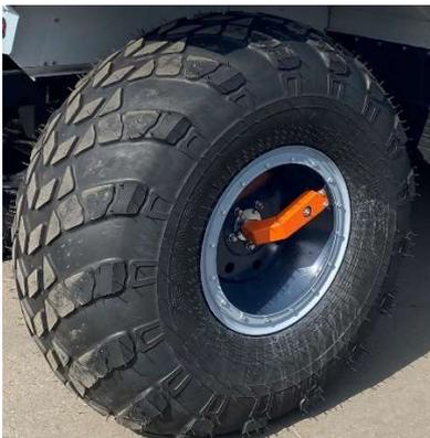
Рис. 20.27 Система централизованной подкачки колёс
