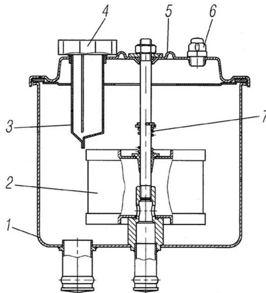
Рис. 6.12 Бачок усилителя рулевого управления:
