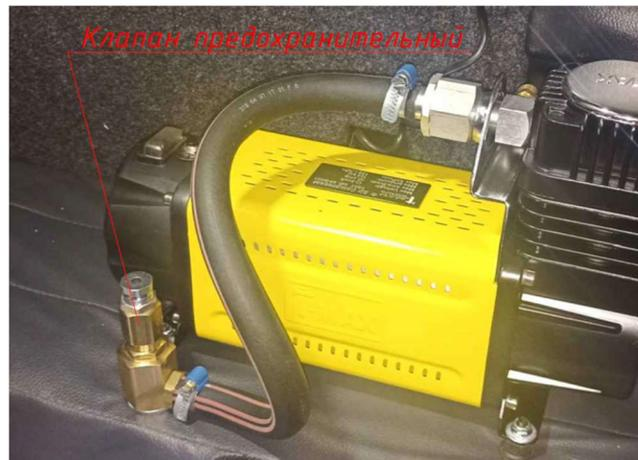
Рис. 20.1. Клапан предохранительный.
