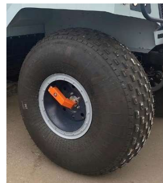
Рис. 19.33 Система централизованной подкачки колёс
