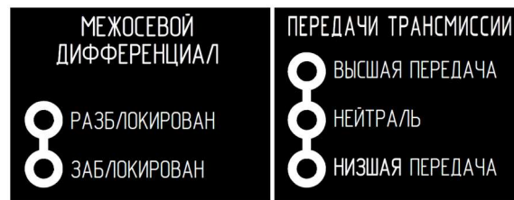
Рис. 6.9 Схема управления раздаточной коробкой
