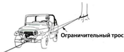
Рис. 19.10 Пример того, как правильно ограничивать автомобиль при транспортировке тяжелых грузов, когда колесных блоков недостаточно. Ограничительный трос или цепь прикрепляется к якорю как можно ниже, проходит под автомобилем и надежно крепится за прочие части установочного комплекта лебедки. Способ крепления к задней раме или балке моста имеет определенный риск. Мощности лебедки достаточно, чтобы сломать или погнуть раму или балку моста
