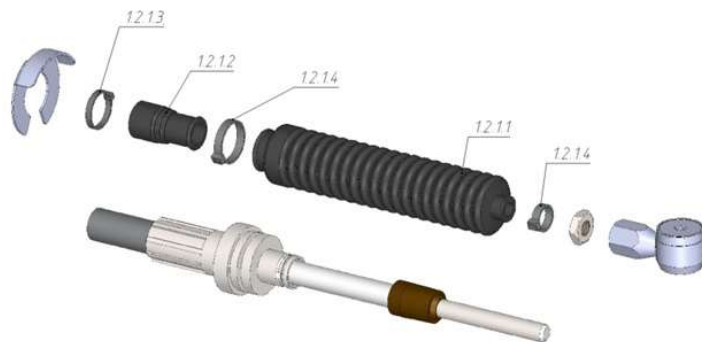
Рис. 6.8 Заменяемые части троса
