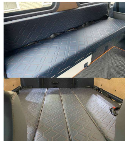
Рис. 19.41 Диваны мягкие пассажирского салона, трансформируемые в спальное место
