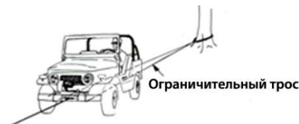
Рис. 19.10 Пример того, как правильно ограничивать автомобиль при транспортировке тяжелых грузов, когда колесных блоков недостаточно. Ограничительный трос или цепь прикрепляется к якорю как можно ниже, проходит под автомобилем и надежно крепится за прочие части установочного комплекта лебедки. Способ крепления к задней раме или балке моста имеет определенный риск. Мощности лебедки достаточно, чтобы сломать или погнуть раму или балку моста
