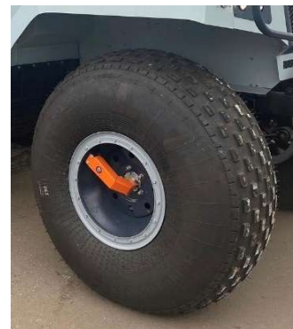
Рис. 19.33 Система централизованной подкачки колёс
