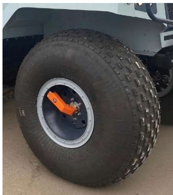
Рис.20.51 Система централизованной подкачки колёс
