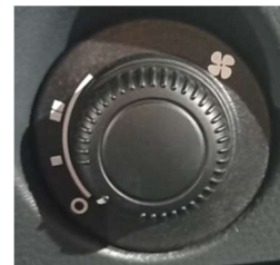
Рис. 5.12 Переключатель вентилятора заднего дополнительного отопителя
