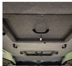
Дополнительный люк на крыше
