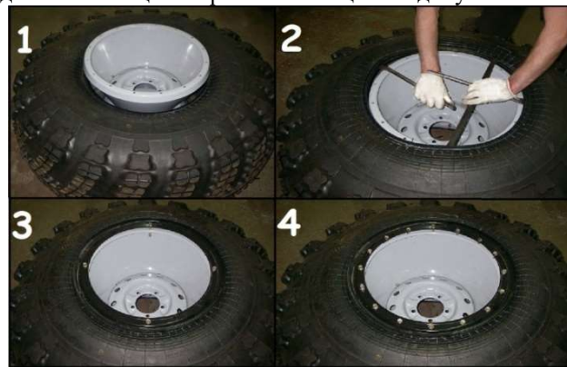
Рис. 10.4 Порядок монтажа шины ТРЭКОЛ
