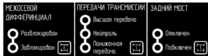
Рис. 6.3 Схема управления раздаточными коробками
