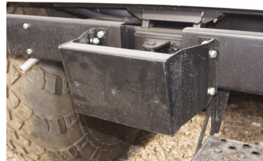
Рис.20.28 Буксирный прибор (фаркоп) с розеткой
