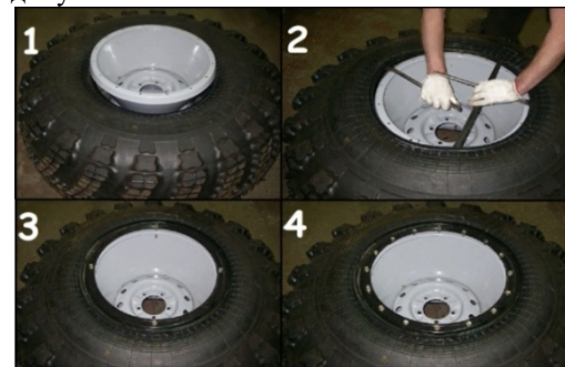
Рис. 10.4 Порядок монтажа шины ТРЭКОЛ
