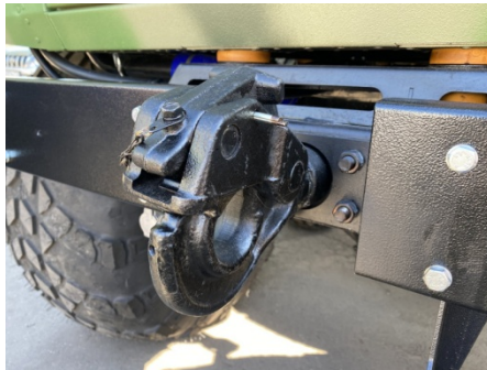
Рис.20.26 Буксирный прибор (фаркоп) с розеткой
