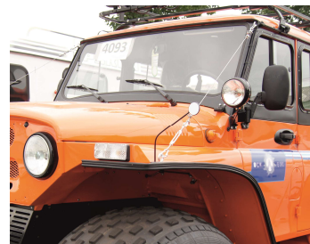
Рис.20.19 Фары-прожекторы с ручками, управляемые из окон ВТС
