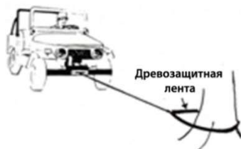
Рис. 20.2 Наиболее распространённый способ, обратите внимание, что в том случае, когда в качестве якоря используется ствол дерева, применяется древозащитная лента. Во избежание нанесения ущерба живой природе не пользуйтесь тросом или цепью. К тому же, трос нельзя обматывать петлей вокруг якоря, поскольку тем самым значительно уменьшается прочность троса на разрыв
