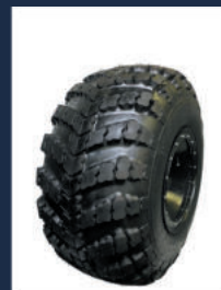
Шина сверхнизкого давления 1280 x 530-533 (2 слоя корда)
