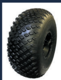
Шина серхнизкого давления 1600 x 700-635 (2/4 слоя корда)
