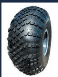
Шина сверхнизкого давления 1750 x 700-635 (4 слоя корда)
