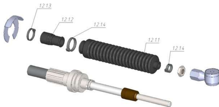
Рис. 6.8 Заменяемые части троса
