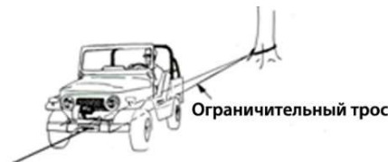
Рис. 20.9 Пример того, как правильно ограничивать автомобиль при транспортировке тяжелых грузов, когда колесных блоков недостаточно. Ограничительный трос или цепь прикрепляется к якорю как можно ниже, проходит под автомобилем и надежно крепится за прочие части установочного комплекта лебедки. Способ крепления к задней раме или балке моста имеет определенный риск. Мощности лебедки достаточно, чтобы сломать или погнуть раму или балку моста
