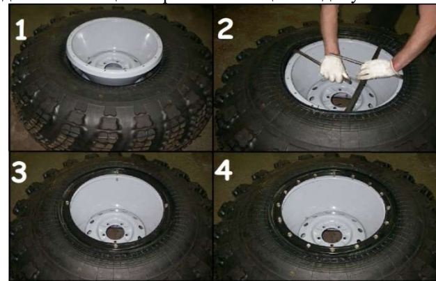
Рис. 10.4 Порядок монтажа шины ТРЭКОЛ
