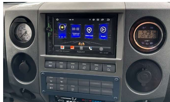
Рис.20.49 Автоматомангинола 2 DIN с монитором (Bluetooth/MP3/USB), динамики, радиоантенна
