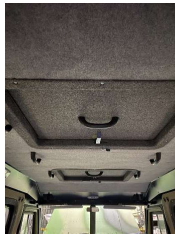
Рис.20.37 Дополнительный люк на крыше
