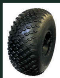
Шина серхнизкого давления 1600 x 700-635 (2/4 слоя корда)
