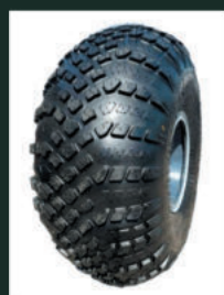
Шина сверхнизкого давления 1750 x 700-635 (4 слоя корда)
