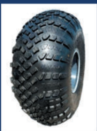
Шина сверхнизкого давления 1750 x 700-635 (4 слоя корда)
