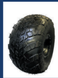
Шина сверхнизкого давления 1350 x 700-533 (2 слоя корда)
