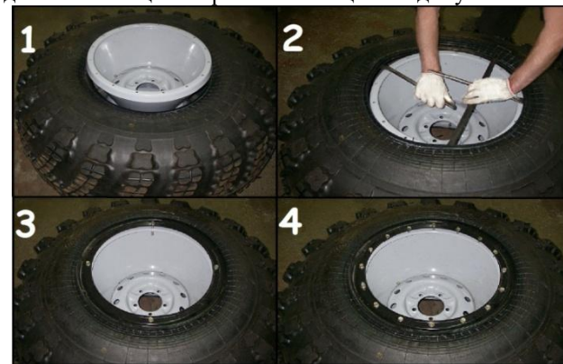
Рис. 10.4 Порядок монтажа шины ТРЭКОЛ
