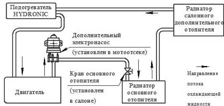
Рис. 20.14 Схема подключения подогревателя к системе охлаждения двигателя
