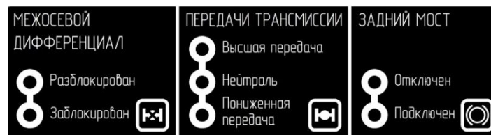
Рис. 6.5 Схема управления раздаточной коробкой и коробкой привода заднего ведущего моста без привода водомётного движителя
