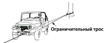
Рис. 20.5 Пример того, как правильно ограничивать автомобиль при транспортировке тяжелых грузов, когда колесных блоков недостаточно. Ограничительный трос или цепь прикрепляется к якорю как можно ниже, проходит под автомобилем и надежно крепится за прочие части установочного комплекта лебедки. Способ крепления к задней раме или балке моста имеет определенный риск. Мощности лебедки достаточно, чтобы сломать или погнуть раму или балку моста
