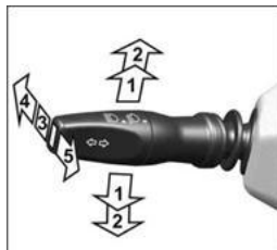
Рис. 5.16 Положение рычага указателей поворота и света фар Для включения указателей поворота: правых – рычаг вверх, левых – рычаг вниз.
