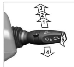
Рис. 5.19 Положения рычага переключателя стеклоочистителя и стеклоомывателя
