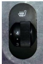
Рис. 5.10 Регулятор управления подогревом сидений
