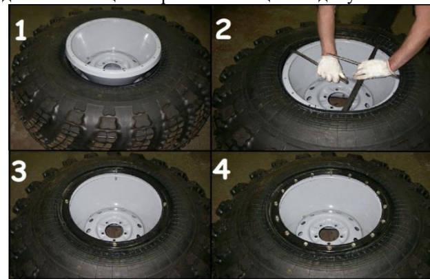
Рис. 10.4 Порядок монтажа шины ТРЭКОЛ
