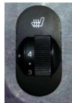
Рис. 5.10 Регулятор управления подогревом сидений
