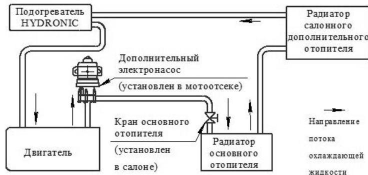
Рис. 20.14 Схема подключения подогревателя к системе охлаждения двигателя
