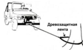
Рис. 20.5 Наиболее распространенный способ, обратите внимание, что в том случае, когда в качестве якоря используется ствол дерева, применяется древозащитная лента. Во избежание нанесения ущерба живой природе не пользуйтесь тросом или цепью. К тому же, трос нельзя обматывать петлей вокруг якоря, поскольку тем самым значительно уменьшается прочность троса на разрыв
