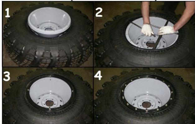
Рис. 10.4 Порядок монтажа шины ТРЭКОЛ
