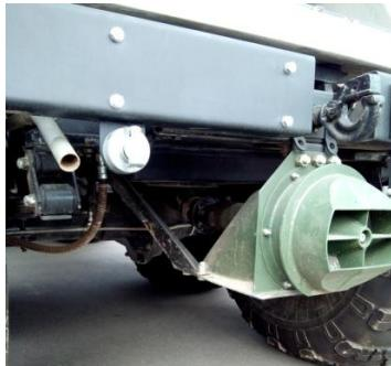
Рис.20.24 Водомётный двигатель
