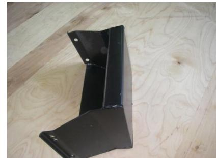
Рис.20.31 Приспособление для установки лодочного мотора
