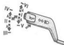
Рис. 5.12 Положение рычага указателей поворота и света фар
