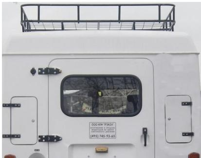
Рис.20.33 Багажник металлический на крышу
