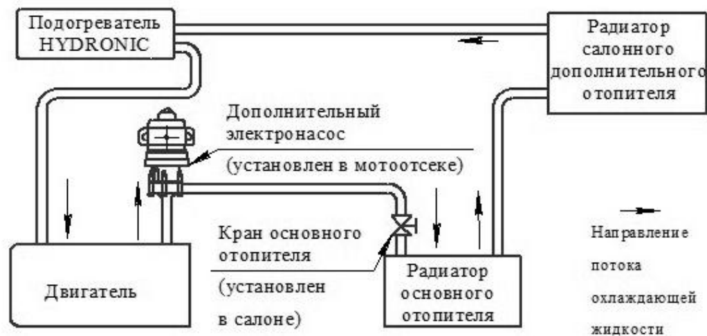
Рис. 19.10 Схема подключения подогревателя к системе охлаждения двигателя
