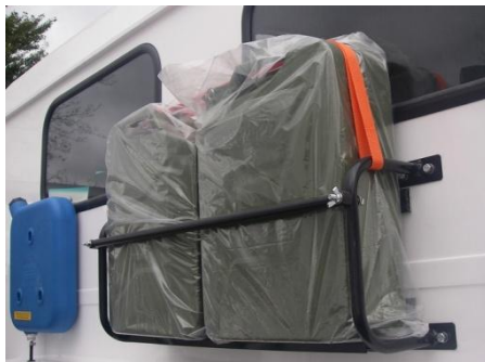
Рис. 19.33 Кронштейны крепления канистр
