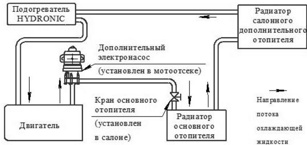
Рис. 19.11 Схема подключения подогревателя к системе охлаждения двигателя
