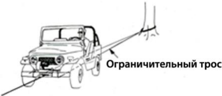
Рис. 19.6 Пример того, как правильно ограничивать автомобиль при транспортировке тяжелых грузов, когда колесных блоков недостаточно. Ограничительный трос или цепь прикрепляется к якорю как можно ниже, проходит под автомобилем и надежно крепится за прочие части установочного комплекта лебедки. Способ крепления к задней раме или балке моста имеет определенный риск. Мощности лебедки достаточно, чтобы сломать или погнуть раму или балку моста
