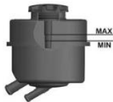
Рис. 6.15 Уровень масла в бачке насоса гидроусилителя
