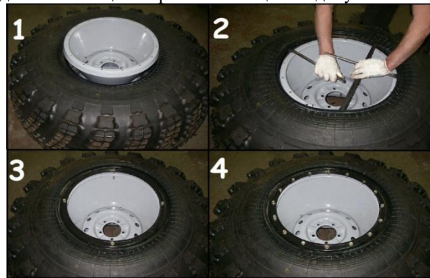
Рис. 10.4 Порядок монтажа шины ТРЭКОЛ
