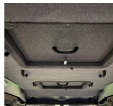
Дополнительный люк на крыше
