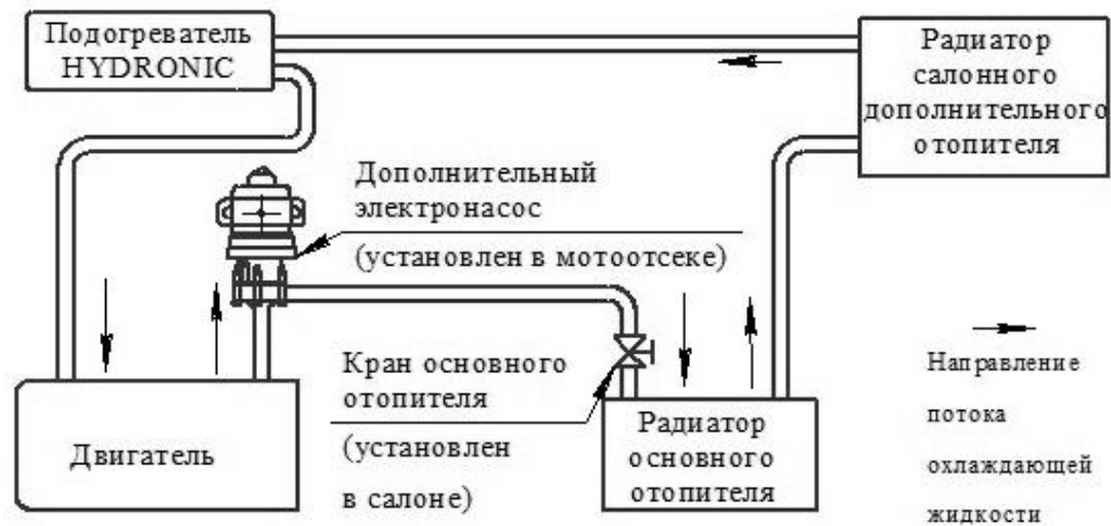
Рис. 19.11 Схема подключения подогревателя к системе охлаждения двигателя
