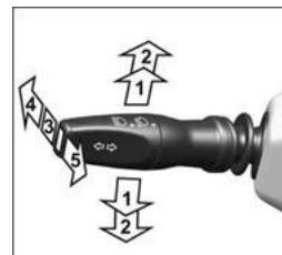
Рис. 5.6 Положение рычага указателей поворота и света фар
