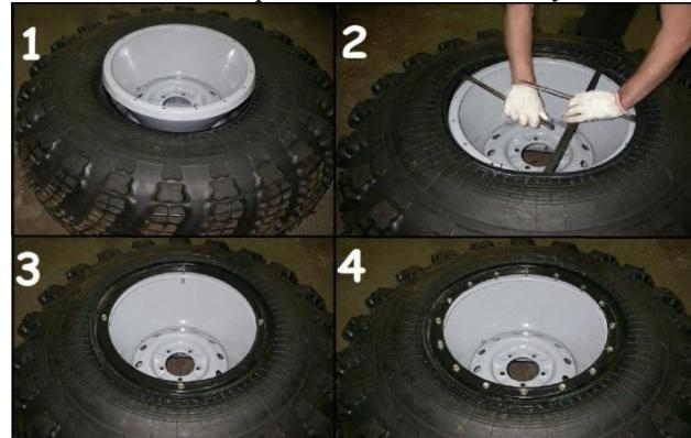
Рис. 10.4 Порядок монтажа шины ТРЭКОЛ
