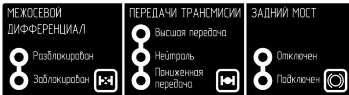
Рис. 6.5 Схема управления раздаточными коробками
