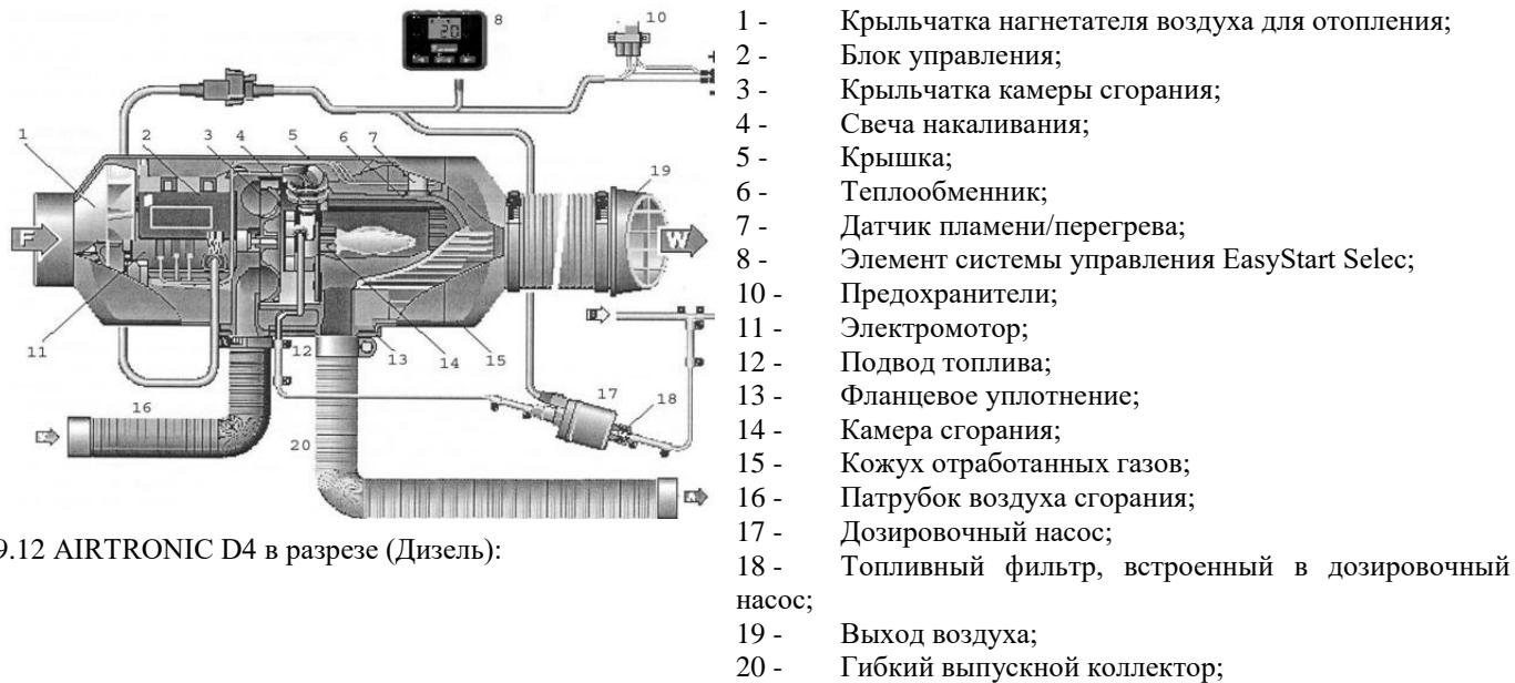
Рис. 19.12 AIRTRONIC D4 в разрезе (Дизель):
