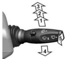
Рис. 5.9 Положения рычага переключателя стеклоочистителя и стеклоомывателя
