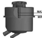
Рис. 6.15 Уровень масла в бачке насоса гидроусилителя
