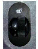
Рис. 5.12 Регулятор управления подогревом передних сидений
