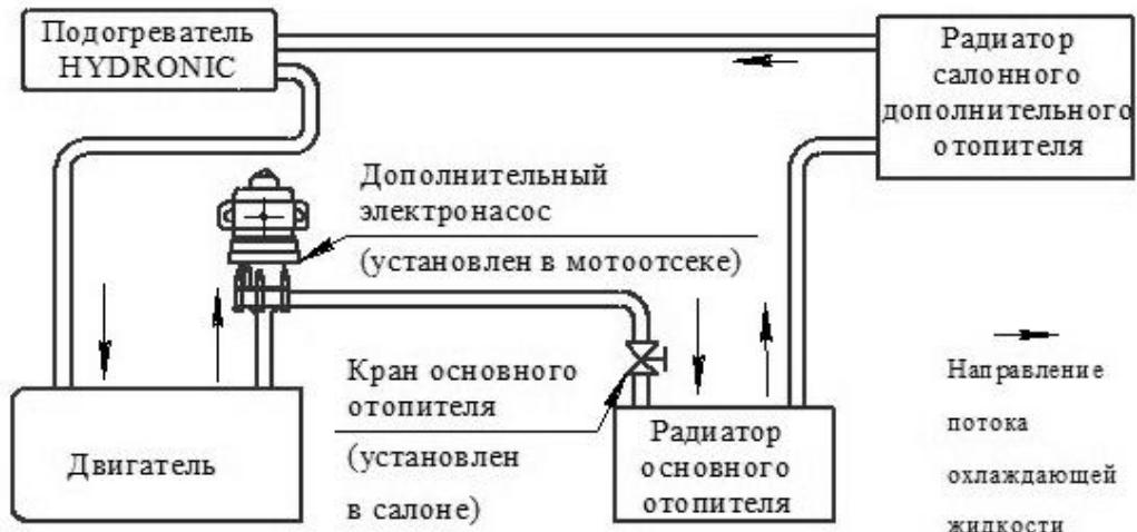
Рис. 19.11 Схема подключения подогревателя к системе охлаждения двигателя
