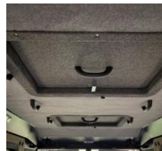
Дополнительный люк на крыше
