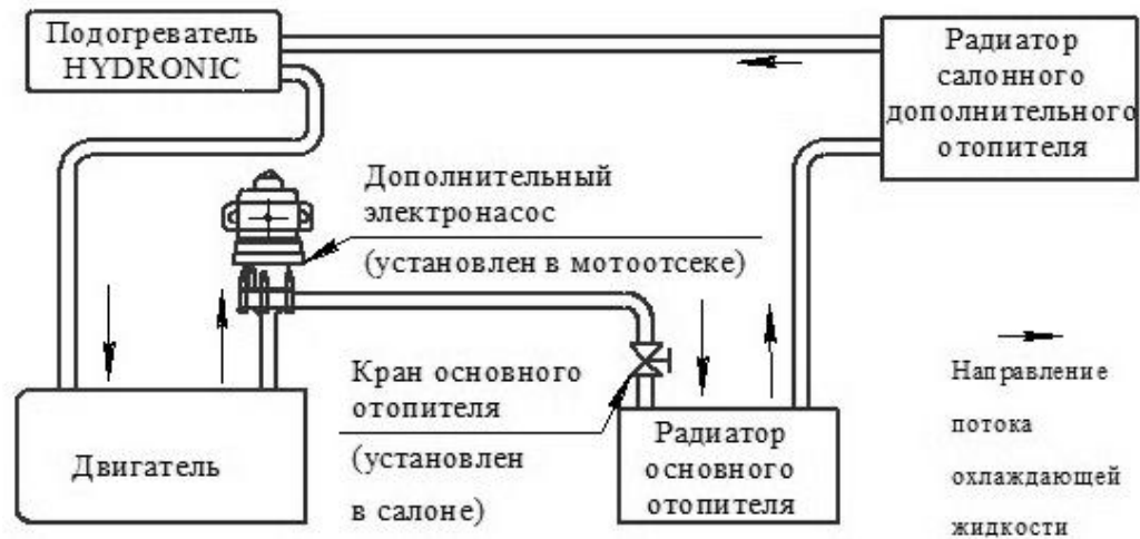
Рис. 19.11 Схема подключения подогревателя к системе охлаждения двигателя
