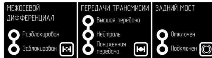
Рис. 6.5 Схема управления раздаточными коробками
