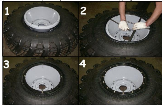
Рис. 10.4 Порядок монтажа шины ТРЭКОЛ
