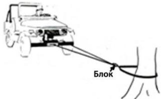
Рис. 19.2 Использование блока дает механическое усилие 2:1. К тому же вдвое уменьшается нагрузка на трос и лебедку. Соответственно, мотор будет крутить быстрее и с меньшим потреблением энергии. Можно работать с длинным тросом и не бояться перегрева мотора
