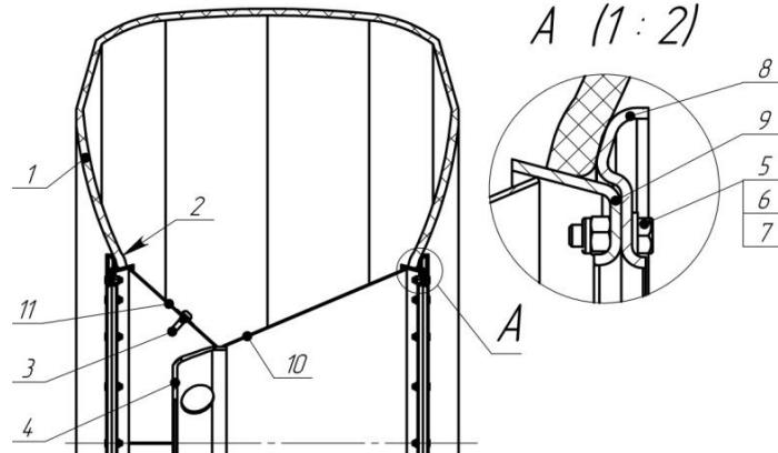
Рис. 10.3 Шина 1600x700-635 ТРЭКОЛ с колесом в сборе
