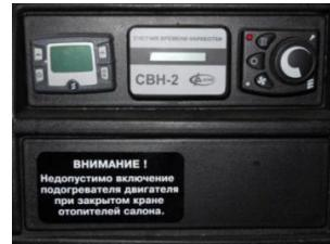
Рис. 19.30 Счётчик моточасов
