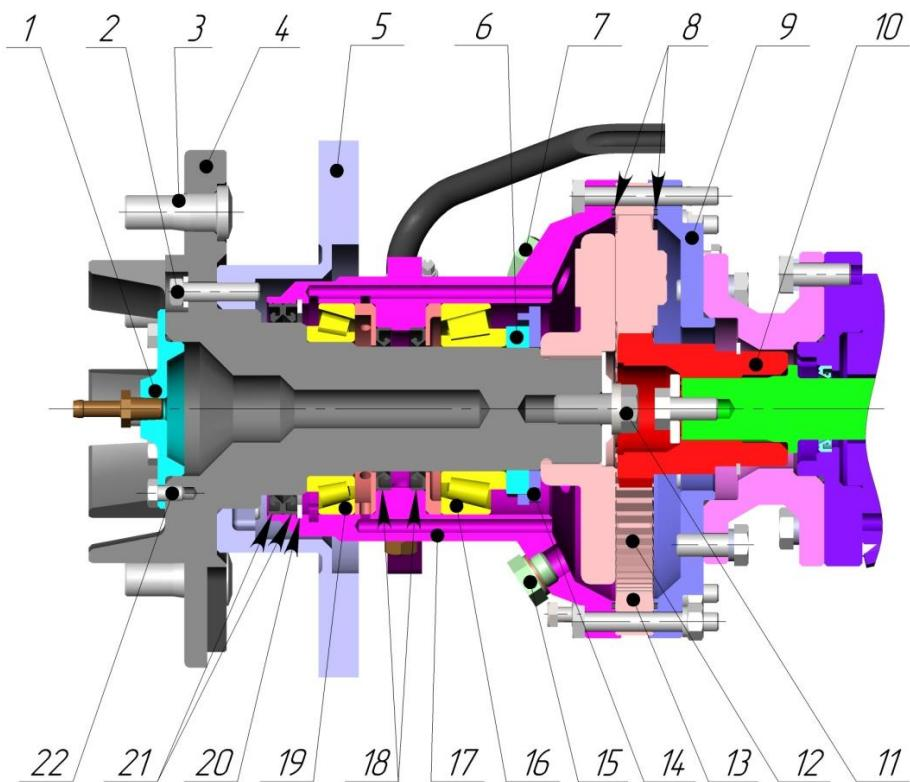
Рис. 6.11 Колесный редуктор
