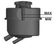
Рис. 6.14 Уровень масла в бачке насоса гидроусилителя
