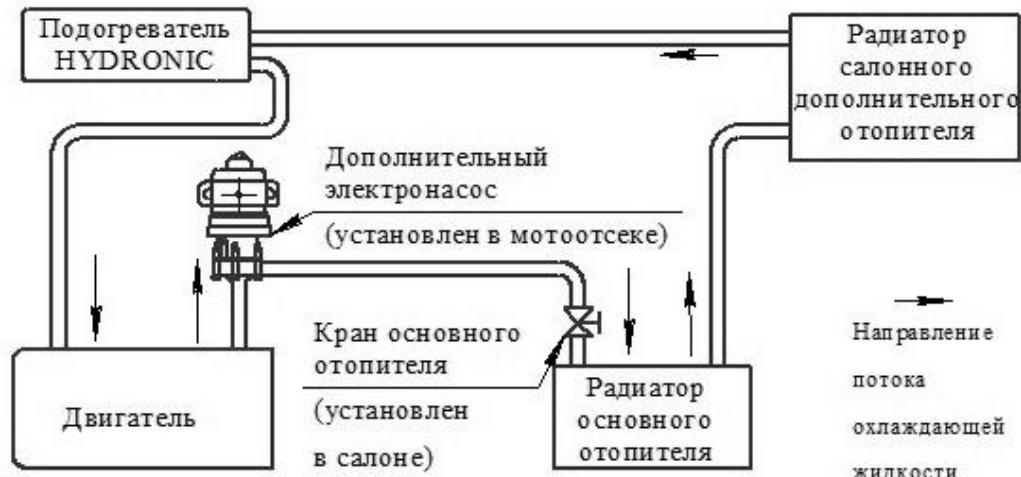
Рис. 19.10 Схема подключения подогревателя к системе охлаждения двигателя
