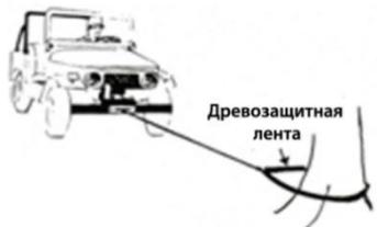
Рис. 19.1 Наиболее распространенный способ, обратите внимание, что в том случае, когда в качестве якоря используется ствол дерева, применяется древозащитная лента. Во избежание нанесения ущерба живой природе не пользуйтесь тросом или цепью. К тому же, трос нельзя обматывать петлей вокруг якоря, поскольку тем самым значительно уменьшается прочность троса на разрыв
