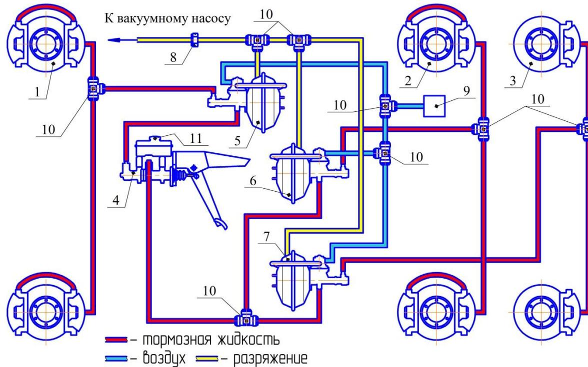
Рис. 6.17 Схема гидропривода тормозов:
