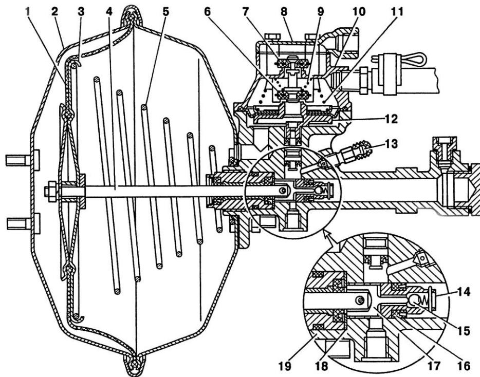
Рис. 6.19 Гидровакуумный усилитель
