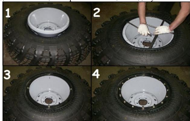
Рис. 10.4 Порядок монтажа шины ТРЭКОЛ
