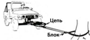
Рис. 19.3 В основном то же, что на рис. 19.2. Цепь с распределителем помогает равномерно распределить нагрузку по составным частям автомобиля
