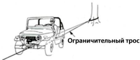
Рис. 19.5 Пример того, как правильно ограничивать автомобиль при транспортировке тяжелых грузов, когда колесных блоков недостаточно. Ограничительный трос или цепь прикрепляется к якорю как можно ниже, проходит под автомобилем и надежно крепится за прочие части установочного комплекта лебедки. Способ крепления к задней раме или балке моста имеет определенный риск. Мощности лебедки достаточно, чтобы сломать или погнуть раму или балку моста
