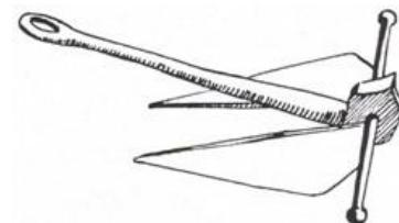
Рис. 19.9 Специальный якорь. В качестве такового лучше всего подходит лодочный якорь. Десятикилограммового якоря достаточно практически в любой почве и легко вытаскивается – достаточно проехать над ним. Для большей эффективности неплохо свести якоря вдвое ближе к стержню
