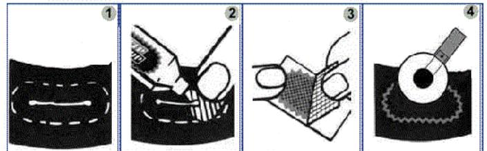
Рис.10.6 Ремонт шины ТРЭКОЛ пластирем (с демонтажем)
