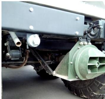
Рис. 19.20 Водомётный движитель
