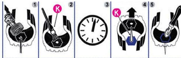
Рис.10.7 Ремонт шины ТРЭКОЛ грибком (с демонтажём)
