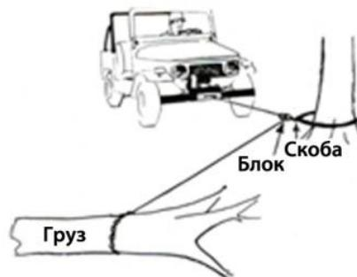
Рис. 19.4 Пример того, как с помощью блока можно менять направление тяги. Блок подсоединяется к древозащитной ленте с помощью соединительной скобы
