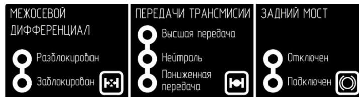
Рис. 6.5 Схема управления раздаточными коробками
