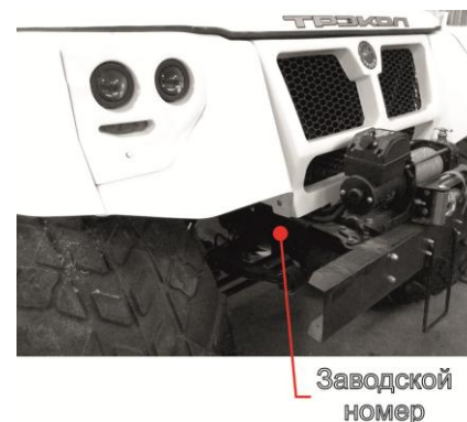
Рис. 4.3 Место обозначения заводского номера ВТС
