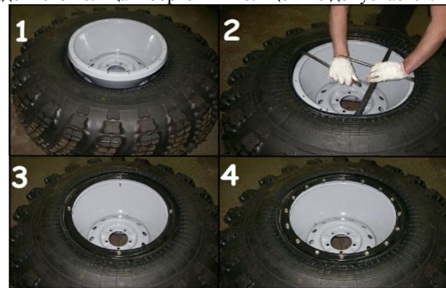
Рис. 10.4 Порядок монтажа шины ТРЭКОЛ
