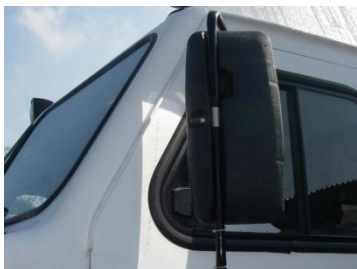
Рис.20.28 Подогрев боковых зеркал заднего вида
