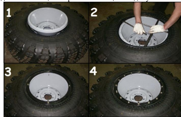
Рис. 10.4 Порядок монтажа шины ТРЭКОЛ
