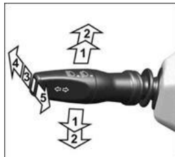
Рис. 5.16 Положение рычага указателей поворота и света фар
