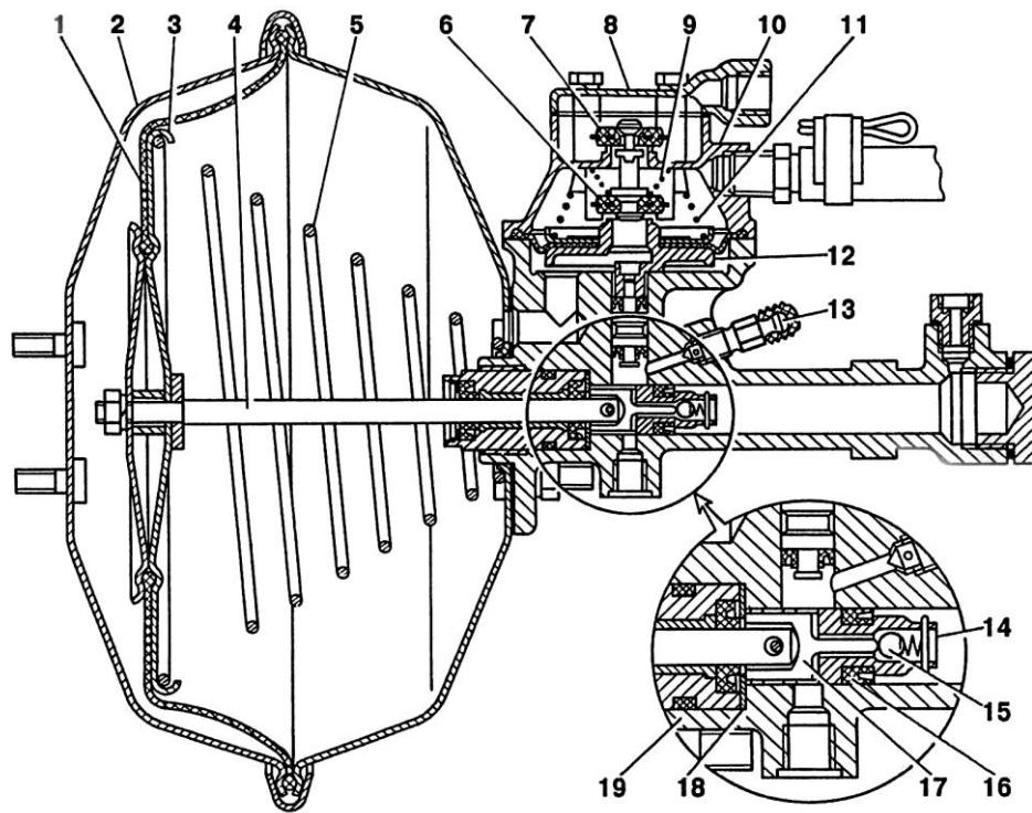
Рис. 6.16 Гидровакуумный усилитель
