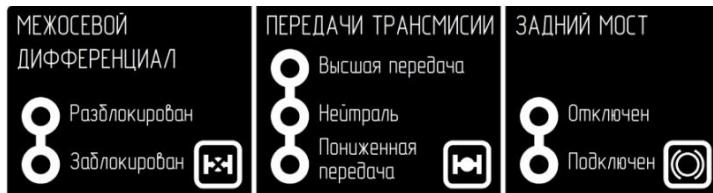
Рис. 6.5 Схема управления раздаточными коробками
