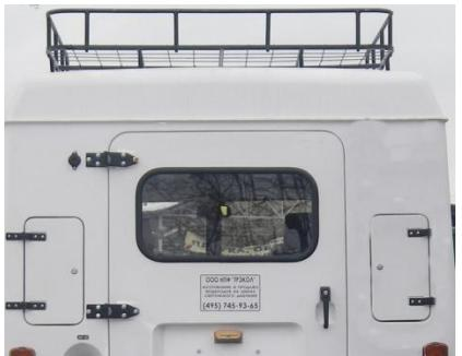
Рис.20.37 Багажник металлический на крышу
