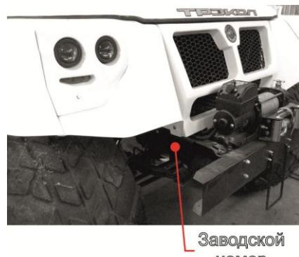
Рис. 4.3 Место обозначения завода номера ВТС
