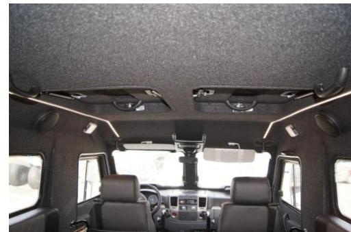
Рис. 20.43 Кузов с внутренним покрытием из карпета
