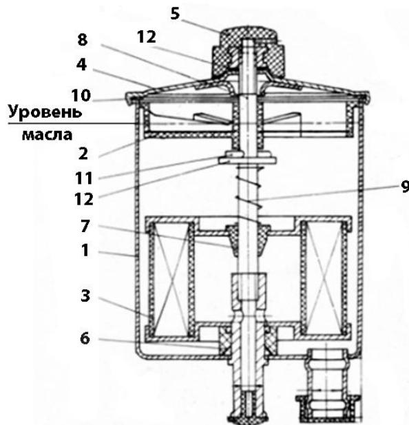
Рис. 6.13 Бачок усилителя рулевого управления:
