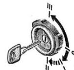
Рис. 5.6 Положения ключа выключателя зажигания, стартера и противоугонного устройства
