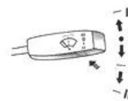
Рис. 5.7 Положения рычага переключателя стеклоочистителя и стеклоомывателя
