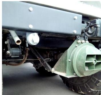
Рис.20.24 Водомётный двигатель
