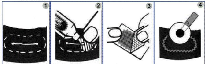
Рис.10.6 Ремонт шины ТРЭКОЛ пластирем (с демонтажем)
