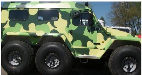
Рис. 20.44 Кузов с наружным покрытием виниловой плёнкой
