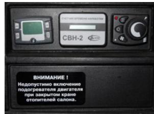
Рис.20.34 Счётчик моточасов
