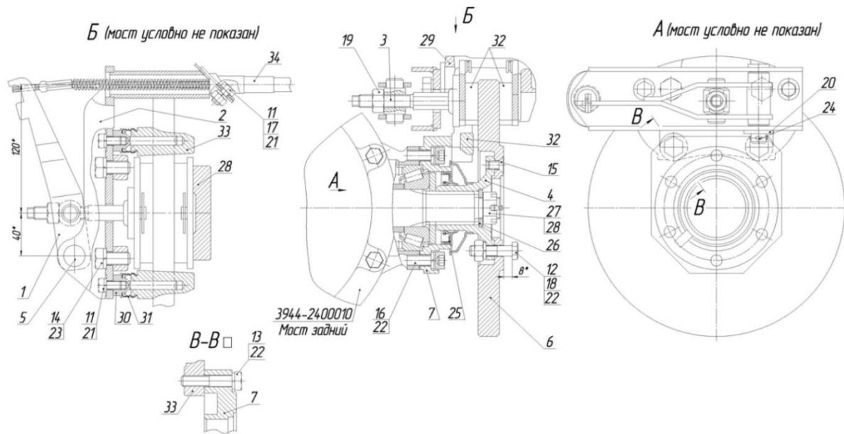
Рис. 6.17 Устройство стояночного тормоза
