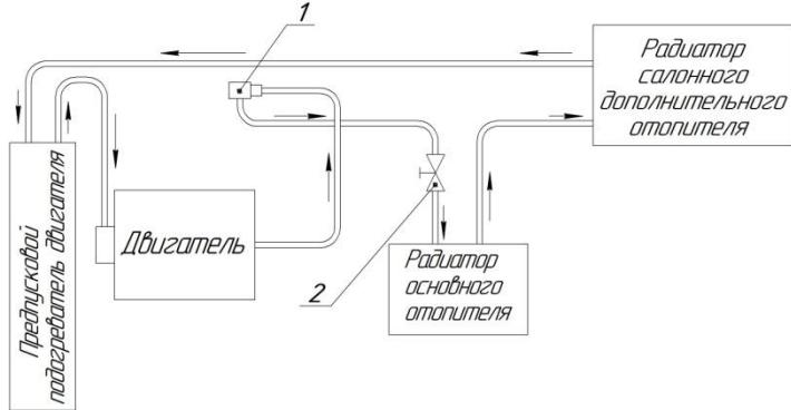
Рис. 6.19. Система отопления:
