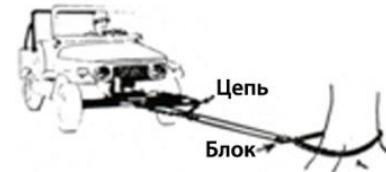
Рис. 20.9 В основном то же, что на рис. 20.8. Цепь с распределителем помогает равномерно распределить нагрузку по составным частям автомобиля
