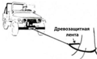
Рис. 20.7 Наиболее распространенный способ, обратите внимание, что в том случае, когда в качестве якоря используется ствол дерева, применяется древозащитная лента. Во избежание нанесения ущерба живой природе не пользуйтесь тросом или цепью. К тому же, трос нельзя обматывать петлей вокруг якоря, поскольку тем самым значительно уменьшается прочность троса на разрыв
