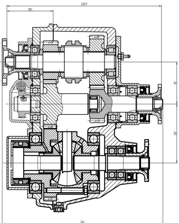
Рис.6.4 Коробка привода заднего ведущего моста с приводом водометного движителя
