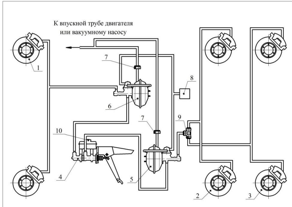
Рис. 6.14 Схема гидропривода тормозов:
