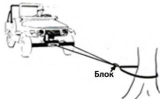
Рис. 20.8 Использование блока дает механическое усилие 2:1. К тому же вдвое уменьшается нагрузка на трос и лебедку. Соответственно, мотор будет крутить быстрее и с меньшим потреблением энергии. Можно работать с длинным тросом и не бояться перегрева мотора
