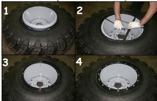
Рис. 10.4 Порядок монтажа шины ТРЭКОЛ
