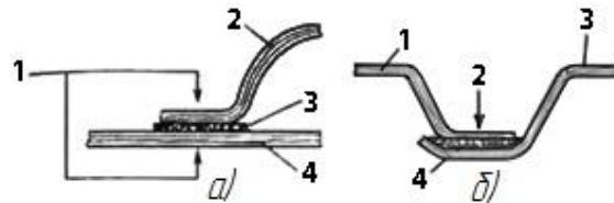
Рис. 6.21. Соединение слоистого пластика склеиванием:
