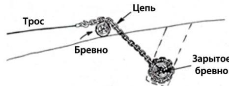
Рис. 20.14 Зарытое в землю бревно – отличный якорь. При необходимости вместо бревна можно использовать целый ряд предметов, например, металлическую балку, трубу или даже большую канистру.
