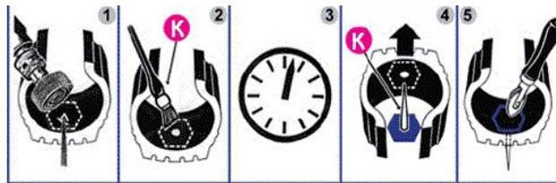
Рис.10.7 Ремонт шины ТРЭКОЛ грибком (с демонтажём)
