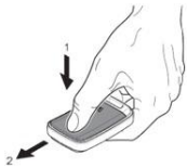
Рис.20.26 Замена батареек в пультах дистанционного управления
