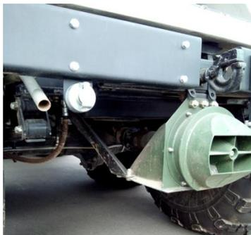
Рис.20.28 Водомётный движитель
