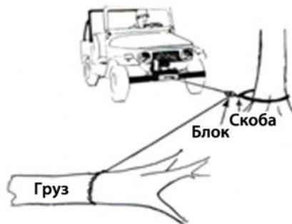
Рис. 20.10 Пример того, как с помощью блока можно менять направление тяги. Блок подсоединяется к древозащитной ленте с помощью соединительной скобы
