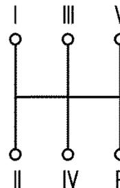
Рис. 6.1 Схема переключения коробками передач
