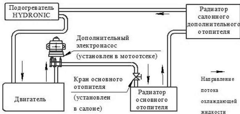
Рис. 20.18 Схема подключения подогревателя к системе охлаждения двигателя
