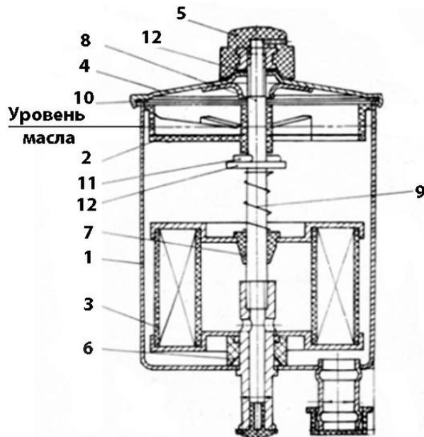
Рис. 6.13 Бачок ШНКФ 453473.300 усилителя рулевого управления:
