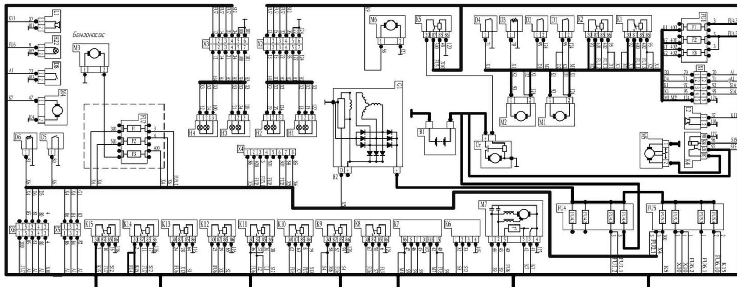
Рис 6.18 (Часть 1) Схема электропитания ТРЭКОЛ 39294
