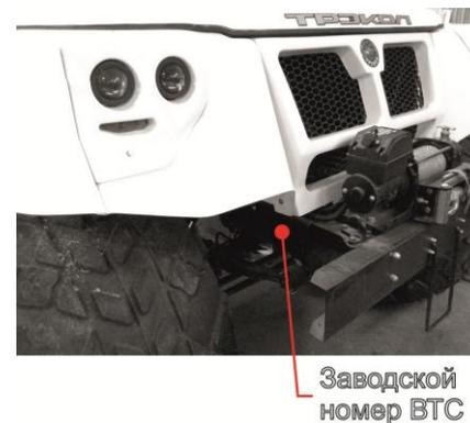
Рис. 4.3 Место обозначения заводского номера ВТС
