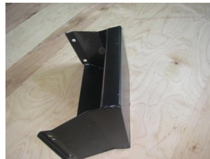
Рис.20.39 Транец для лодочного мотора
