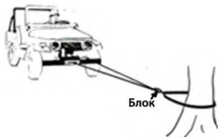
Рис. 20.8 Использование блока дает механическое усилие 2:1. К тому же вдвое уменьшается нагрузка на трос и лебедку. Соответственно, мотор будет крутить быстрее и с меньшим потреблением энергии. Можно работать с длинным тросом и не бояться перегрева мотора
