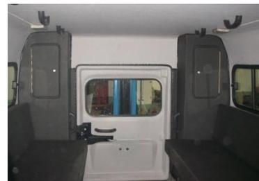
Рис. 20.47 Кузов с внутренним покрытием из кожзаменителя
