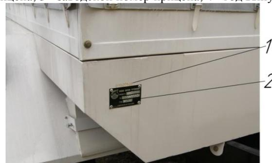
Рис. 20.3 Место обозначения заводского номера прицепа и расположение таблички заводских данных:
