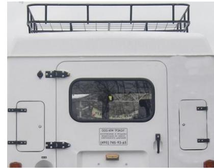
Рис.20.42 Багажник стальной на крышу
