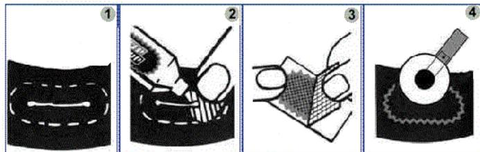
Рис.10.4 Ремонт шины ТРЭКОЛ пластырем (с демонтажем)
