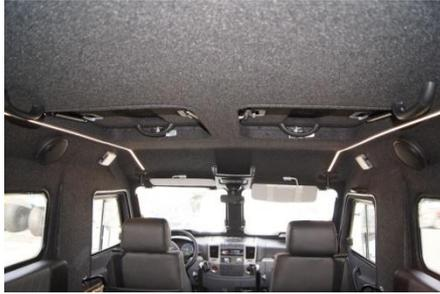
Рис. 20.48 Кузов с внутренним покрытием из ковролина
