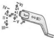
Рис. 5.5 Положение рычага указателей поворота и света фар
