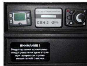
Рис.20.38 Счётчик моточасов
