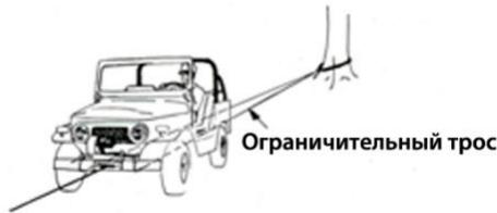
Рис. 20.11 Пример того, как правильно ограничивать автомобиль при транспортировке тяжелых грузов, когда колесных блоков недостаточно. Ограничительный трос или цепь прикрепляется к якорю как можно ниже, проходит под автомобилем и надежно крепится за прочие части установочного комплекта лебедки. Способ крепления к задней раме или балке моста имеет определенный риск. Мощности лебедки достаточно, чтобы сломать или погнуть раму или балку моста
