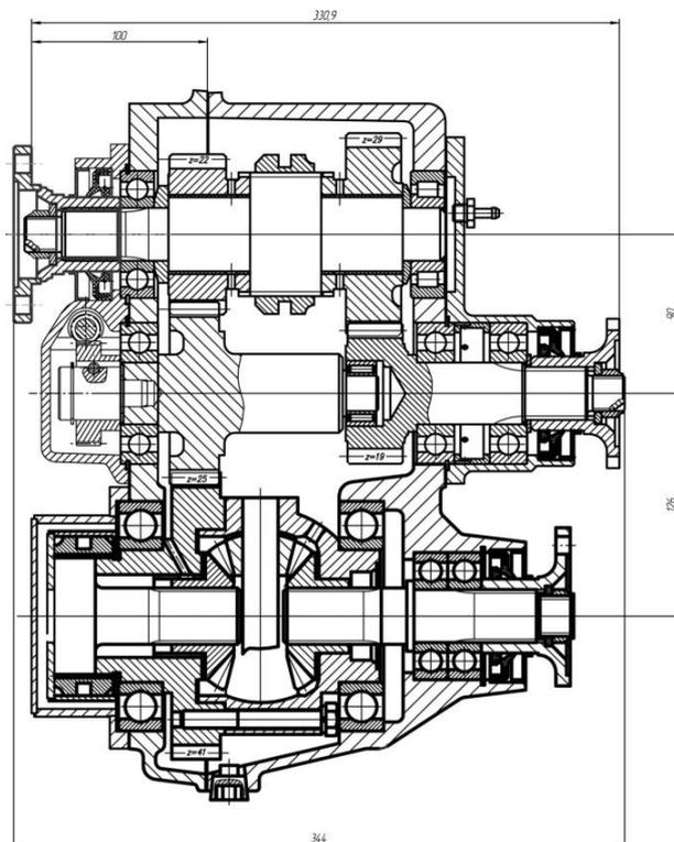
Рис.6.4 Коробка раздаточная задняя с приводом водометного движителя
