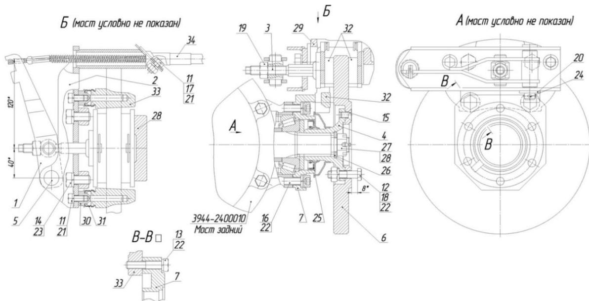
Рис. 6.17 Устройство стояночного тормоза
