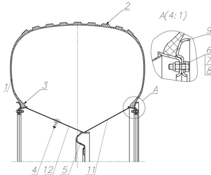
Рис. 10.1 Шина 1300x600-533 ТРЭКОЛ с колесом в сборе
