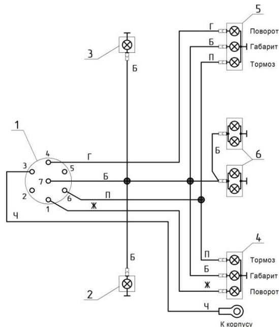
Рис. 20.5 Схема электрооборудования прицепа:
