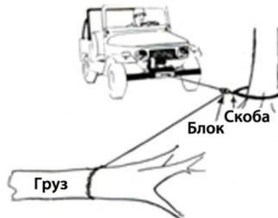
Рис. 20.9 Пример того, как с помощью блока можно менять направление тяги. Блок подсоединяется к древозащитной ленте с помощью соединительной скобы
