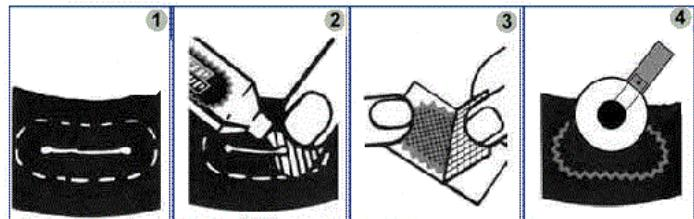
Рис.10.4 Ремонт шины ТРЭКОЛ пластирем (с демонтажем)
