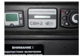
Рис.20.35 Счётчик моточасов
