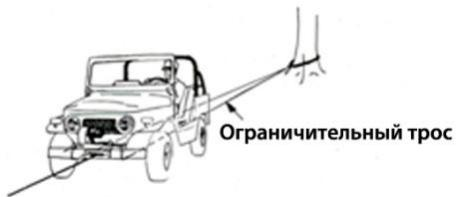
Рис. 20.10 Пример того, как правильно ограничивать ВТС при транспортировке тяжелых грузов, когда колесных блоков недостаточно. Ограничительный трос или цепь прикрепляется к якорю как можно ниже, проходит под ВТС и надежно крепится за прочие части установочного комплекта лебедки. Способ крепления к задней раме или балке моста имеет определенный риск. Мощности лебедки достаточно, чтобы сломать или погнуть раму или балку моста
