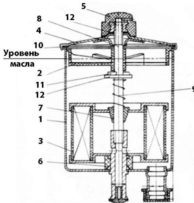
Рис. 6.5 Бачок ШНКФ 453473.300 усилителя рулевого управления:
