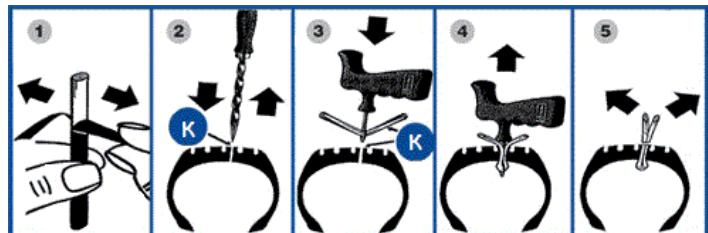
Рис.10.3 Ремонт шины ТРЭКОЛ шнуром (без демонтажа)
