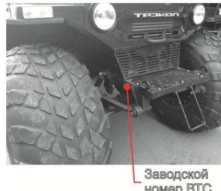
Рис. 4.3 Место обозначения заводского номера ВТС
