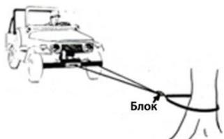
Рис. 20.7 Использование блока дает механическое усиление 2:1. К тому же вдвое уменьшается нагрузка на трос и лебёдку. Соответственно, мотор будет крутить быстрее и с
