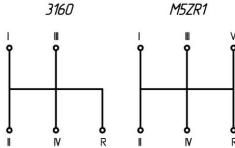
Рис. 6.1 Схемы переключения коробок передач УАЗ-3160 и M5ZR1
