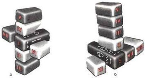
Рисунок 5.5 Рычаг переключателя стеклоочистителя и смывателя имеет положения:
