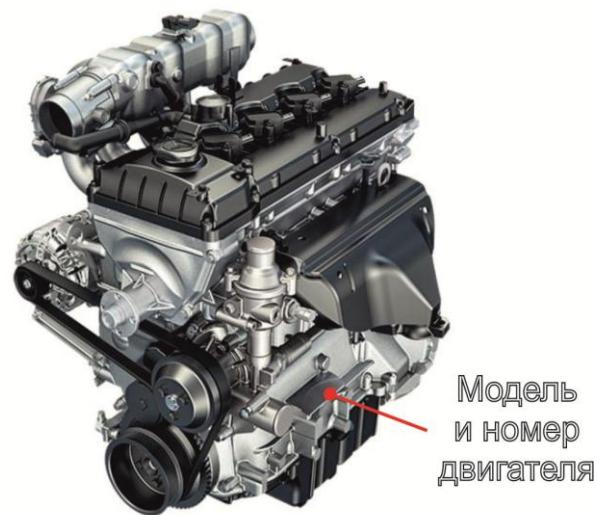
Рисунок 4.5 Модель и номер бензинового двигателя ЗМЗ 40905.10
