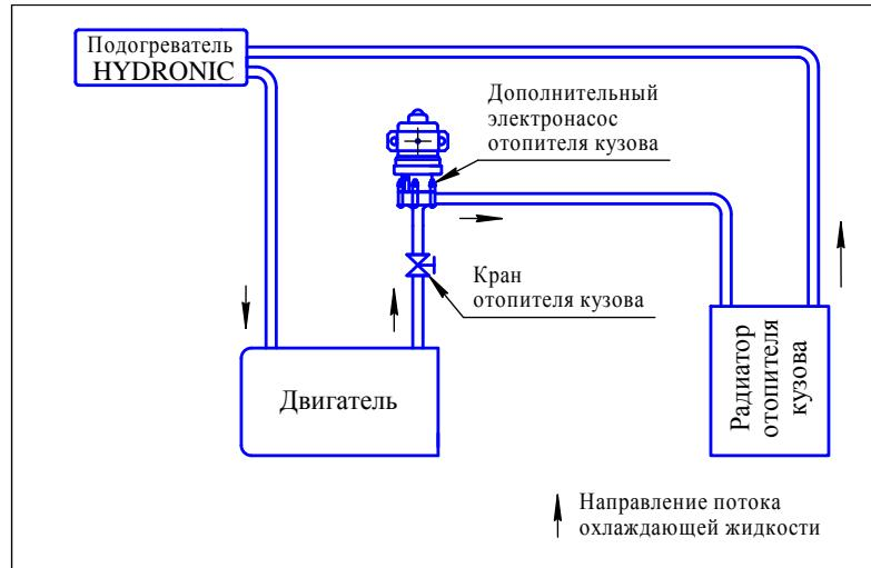
Рис. 20.17 Схема подключения подогревателя к системе охлаждения двигателя
