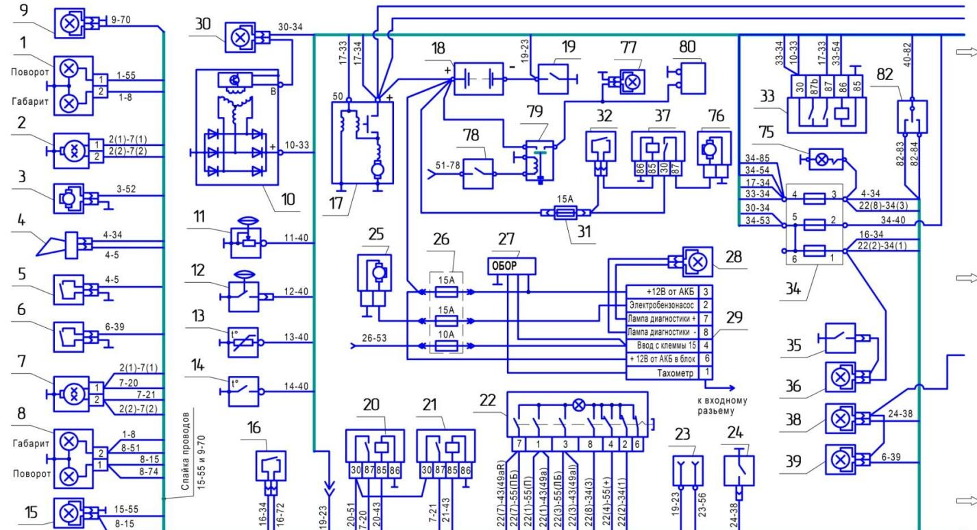
Рис. 6.7 (часть 1) Схема электропитания ТРЭКОЛ 39041
