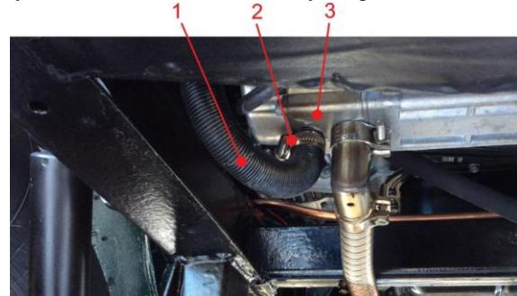
Рис. 8.1 Обслуживание предпускового подогревателя после преодоления водных преград
