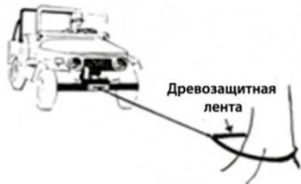
Рис. 20.6 Наиболее распространённый способ, обратите внимание, что в том случае, когда в качестве якоря используется ствол дерева, применяется древозащитная лента. Во избежание нанесения ущерба живой природе не пользуйтесь тросом или цепью. К тому же, трос нельзя обматывать петлей вокруг якоря, поскольку тем самым значительно уменьшается прочность троса на разрыв
