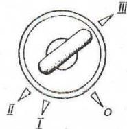
Рисунок 5.4 Положения ключа в выключателе зажигания:
