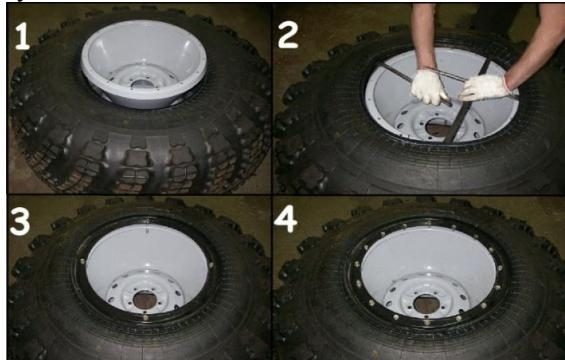
Рис. 10.2 Порядок монтажа шины ТРЭКОЛ
