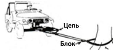
Рис. 20.8 В основном то же, что на рис. 20.8. Цепь с распределителем помогает равномерно распределить нагрузку по составным частям автомобиля.
