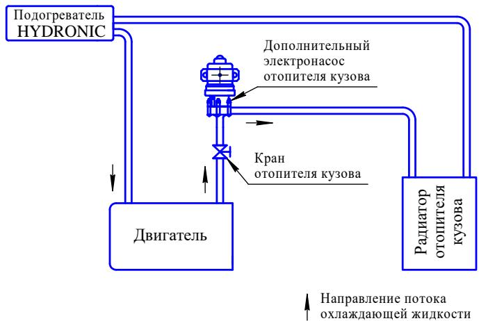
Рис. 20.11 Схема подключения подогревателя к системе охлаждения двигателя
