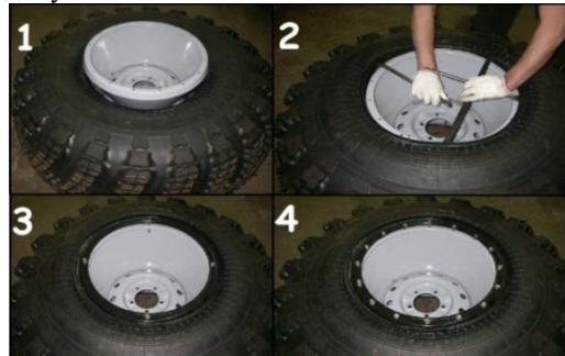
Рис. 10.4 Порядок монтажа шины ТРЭКОЛ
