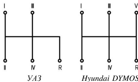
Рис. 6.1 Схемы переключения коробок передач УАЗ и Hyundai DYMOS
