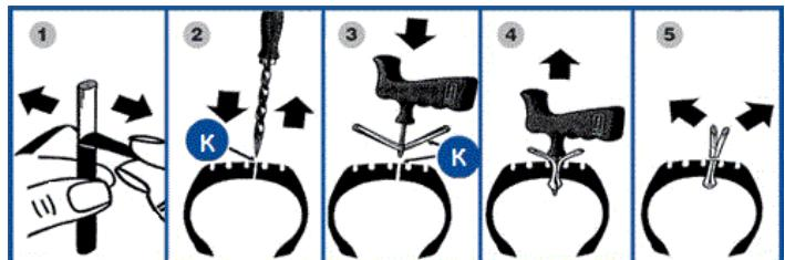
Рис.10.5 Ремонт шины ТРЭКОЛ шнуром (без демонтажа)
