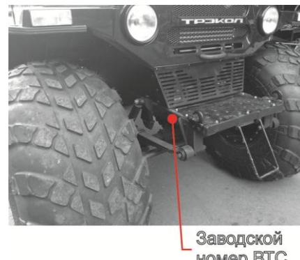
Рис. 4.3 Место обозначения завода ВТС
