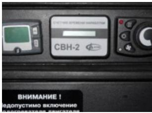
Рис.20.27 Счётчик моточасов
