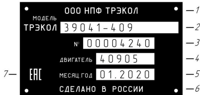
Рис. 4.2 Табличка заводских данных ВТС:
