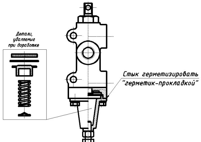
Рис. 20.1. Доработка крана управления.
