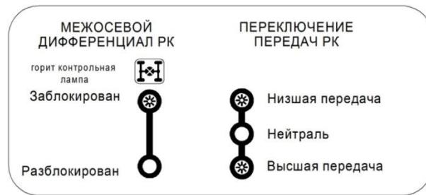
Рис. 6.2 Схема управления раздаточной коробкой
