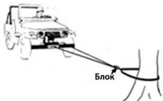
Рис. 20.3 Использование блока дает механическое усиление 2:1. К тому же вдвое уменьшается нагрузка на трос и лебёдку. Соответственно, мотор будет крутить быстрее и с
