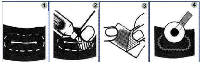
Рис.10.6 Ремонт шины ТРЭКОЛ пластирем (с демонтажем)
