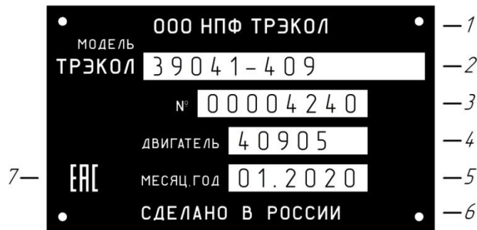
Рис. 4.2 Табличка заводских данных ВТС:
