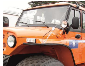
Рис.20.21 Фары-прожекторы с ручками, управляемые из окон ВТС
