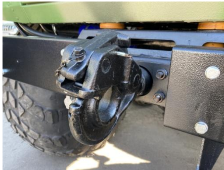
Рис.20.28 Буксирный прибор (фаркоп) с розеткой
