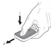
Рис. 20.17 Замена батареек в пультах дистанционного управления
