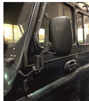
Рис.20.25 Подогрев боковых зеркал
