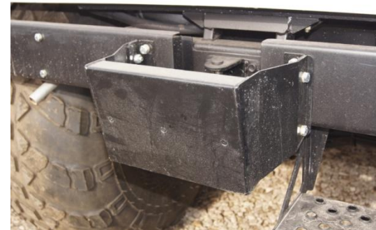
Рис.20.30 Буксирный прибор (фаркоп) с розеткой
