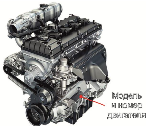
Рисунок 4.5 Модель и номер бензинового двигателя 3МЗ-40905.10, 3МЗ-409051.10 и 3МЗ-409052.10
