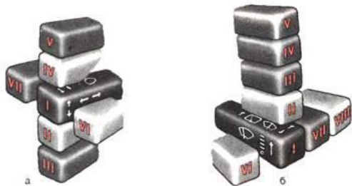
Рисунок 5.5 Рычаг переключателя стеклоочистителя и омывателя имеет положения:
