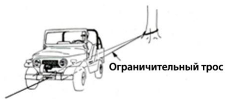
Рис. 20.6 Пример того, как правильно ограничивать ВТС при транспортировке тяжелых грузов, когда колесных блоков недостаточно. Ограничительный трос или цепь прикрепляется к якорю как можно ниже, проходит под ВТС и надежно крепится за прочие части установочного комплекта лебедки. Способ крепления к задней раме или балке моста имеет определенный риск. Мощности лебедки достаточно, чтобы сломать или погнуть раму или балку моста
