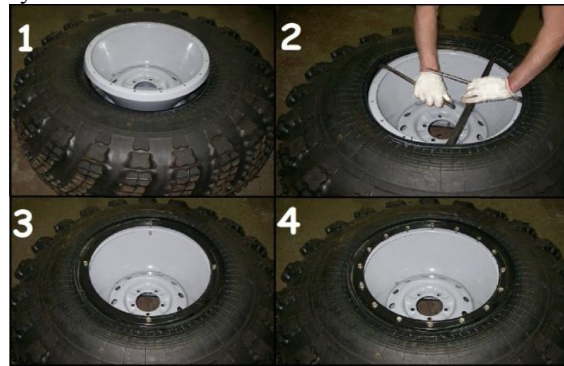
Рис. 10.4 Порядок монтажа шины ТРЭКОЛ
