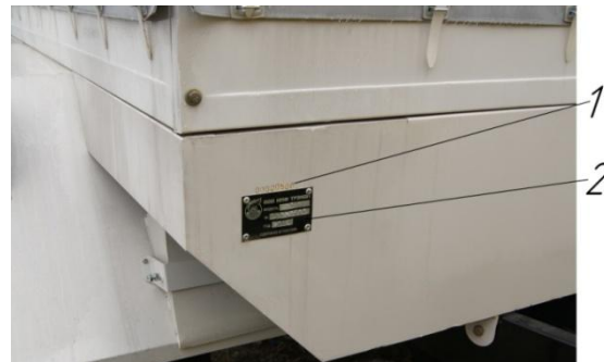
Рис. 20.2 Место обозначения заводского номера прицепа и расположение таблички заводских данных:
