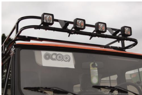
Рис. 20.28 Галогеновые фары на багажник
