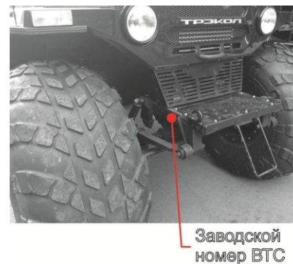
Рис. 4.3 Место обозначения заводского номера ВТС
