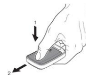
Рис.20.25 Замена батареек в пультах дистанционного управления
