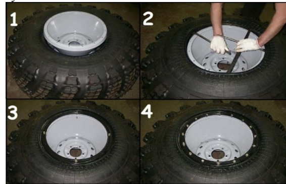
Рис. 10.4 Порядок монтажа шины ТРЭКОЛ
