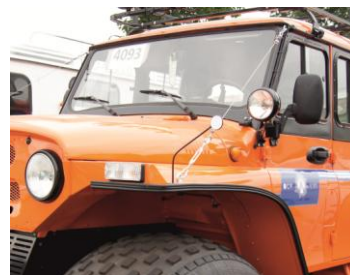
Рис.20.29 Фары-искатели с ручками, управляемые из окон ВТС
