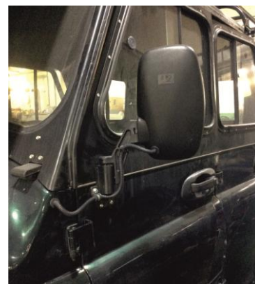
Рис.20.33 Подогрев боковых зеркал
