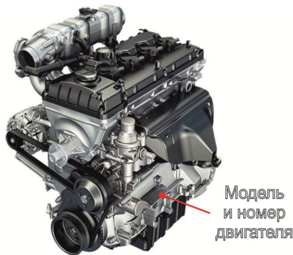
Рисунок 4.5 Модель и номер бензинового двигателя ЗМЗ 40905.10
