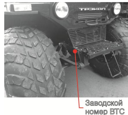
Рис. 4.3 Место обозначения заводского номера ВТС
