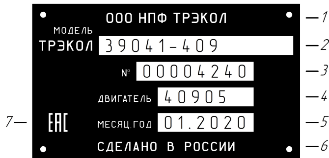
Рис. 4.2 Табличка заводских данных ВТС:
