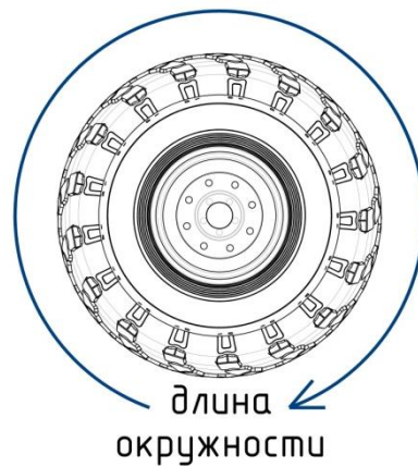
Рис. 10.2 Длина окружности колеса
