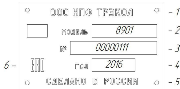
Рис. 20.1 Табличка заводских данных прицепа: 1 - наименование предприятия-изготовителя; 2 - модель прицепа; 3 - заводской номер прицепа; 4 - год выпуска; 5 - страна происхождения; 6 - знак «ЕАС»
