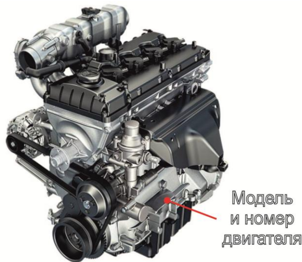
Рисунок 4.5 Модель и номер бензинового двигателя ЗМЗ 40905
